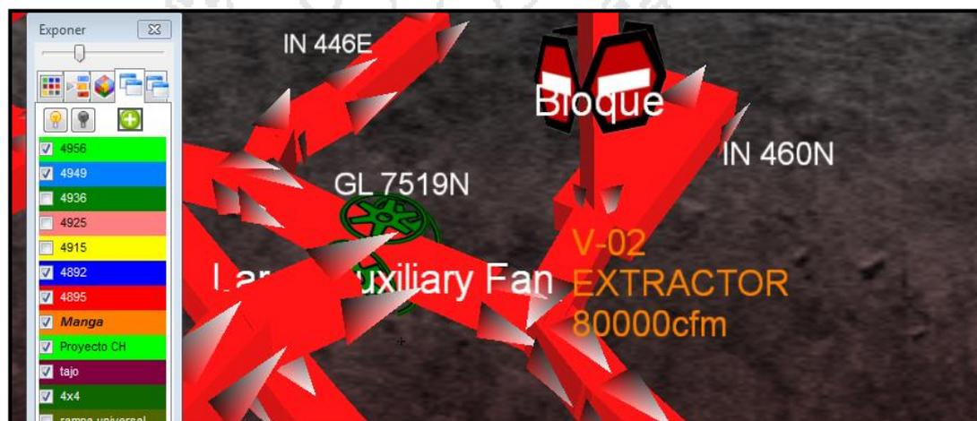
Figura 5.7 Ventilador instalado subsistema I en GL 7519N como extractor. Fuente: Elaboración propia.
