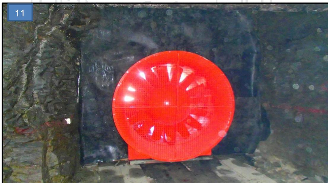
**Fotografía 11:** Ventilador instalado de 100 mil cfm como extractor en el subsistema III nivel 4949, cruceo 512 Oeste.
