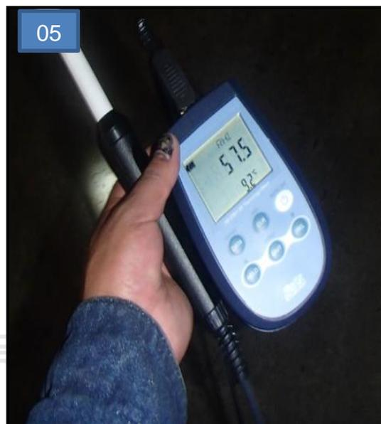
**Fotografía 04 y 05:** Equipo detector de gases marca ALTAIR I5 MSA y equipo de medición de humedad relativa marca Delta OHM.
