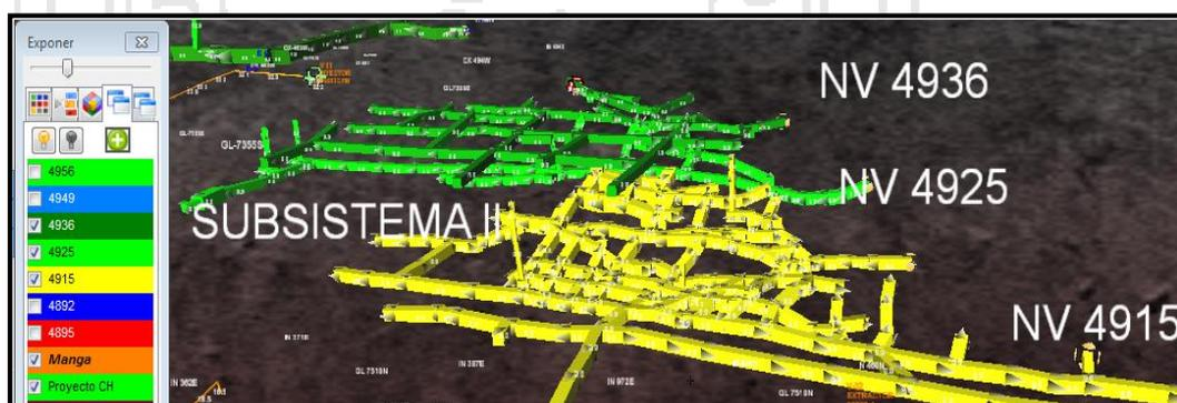
Figura 5.3 Subsistema II de ventilación en ventsim visual. Fuente: Elaboración propia.
