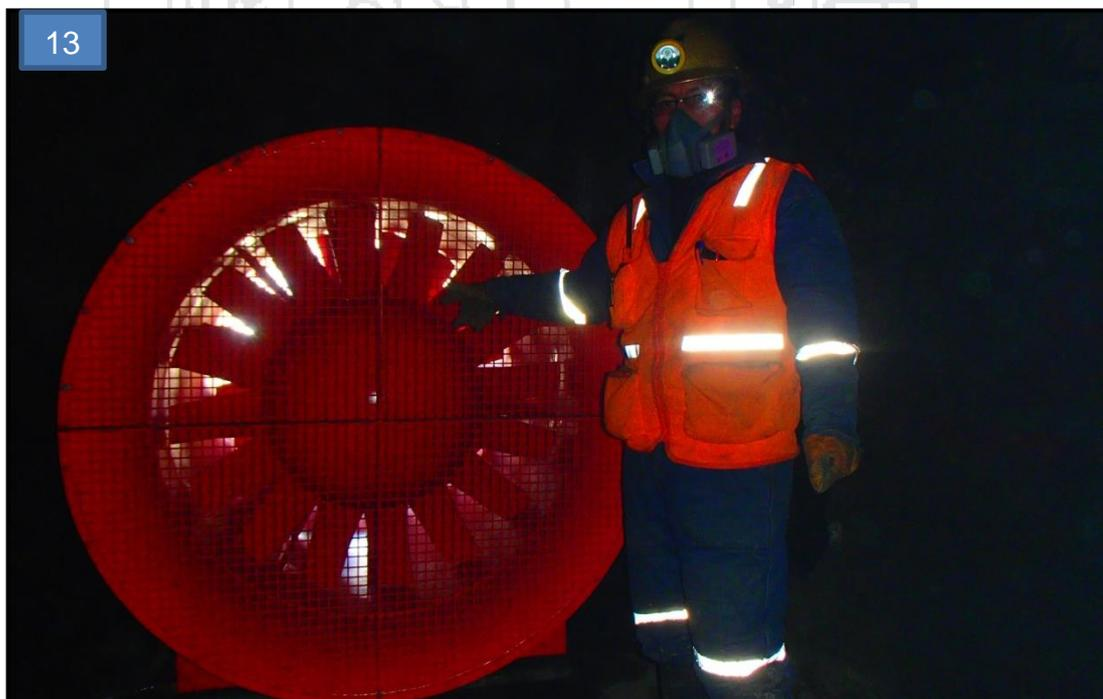
**Fotografía 13:** Ventilador instalado de 80 mil cfm como extractor en el subsistema I nivel 4892, galería 7519 norte.
