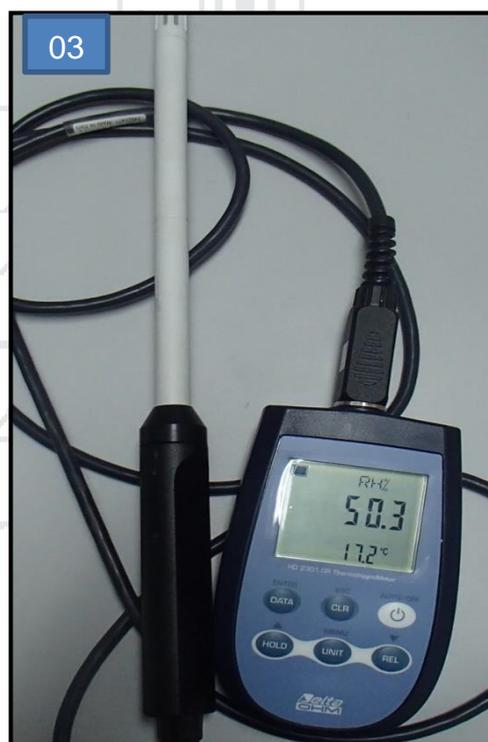
**Fotografía 02 y 03:** Termoanómetro e higrómetro ambos de marca Delta OHM
