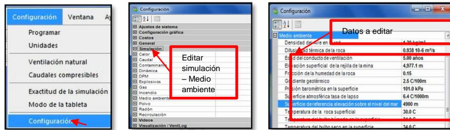
Imagen 12. Edición y/o calibración de datos en Ventsim Visual.
