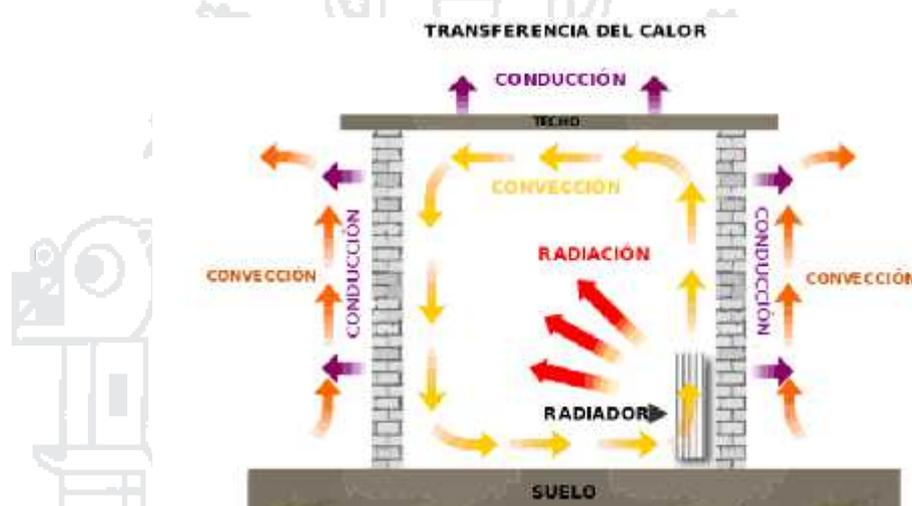
**Figura 3. Diferentes mecanismos de transferencia de calor.**
