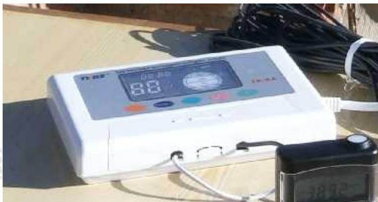
**Figura 5. Controlador microcomputador solar.**
