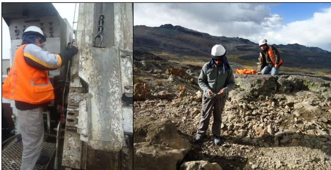
*Figura 9.- Supervisión de Inclinación y Dirección del Taladro*
