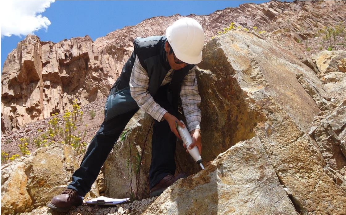
Foto 15 : Toma de datos de resistencia de las paredes de las discontinuidades con martillo Schmidt.
