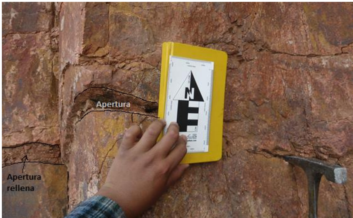
Foto 13 : Reconocimiento y medición de la apertura y apertura rellena de las discontinuidades presentes en el talud del Cerro Espinal.
