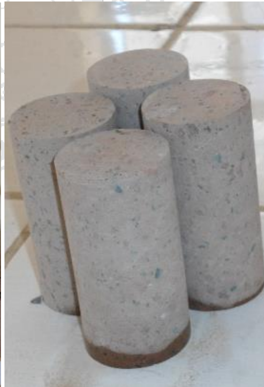
Foto 16 : Equipo de laboratorio de mecánica de rocas y probetas de roca para la realización de ensayos de compresión simple.
