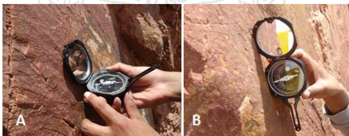
Foto 10 : Toma de datos estructurales en el campo de 108 planos de discontinuidades con brújula Brunton de forma correcta. A, Toma de datos de la dirección de buzamiento de los planos. B, Toma de datos del buzamiento de los planos.
