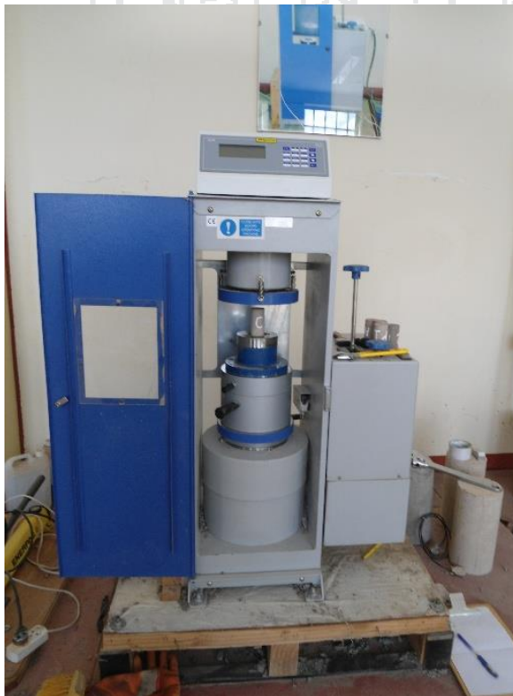
Foto 16 : Equipo de laboratorio de mecánica de rocas y probetas de roca para la realización de ensayos de compresión simple.
