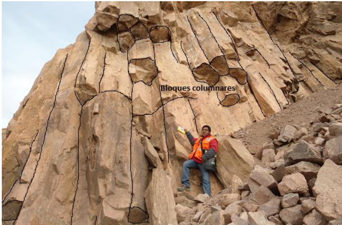
Foto 05 : Afloramiento de Tobas Cristalolíticas del Grupo Mitu que conforma el talud del Cerro Espinal. Se resalta la presencia de bloques columnares estructuralmente controlados.
