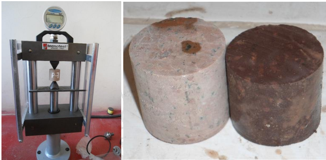
Foto 17 : Equipo de laboratorio de mecánica de rocas y probetas de roca para la realización de ensayos de carga puntual.
