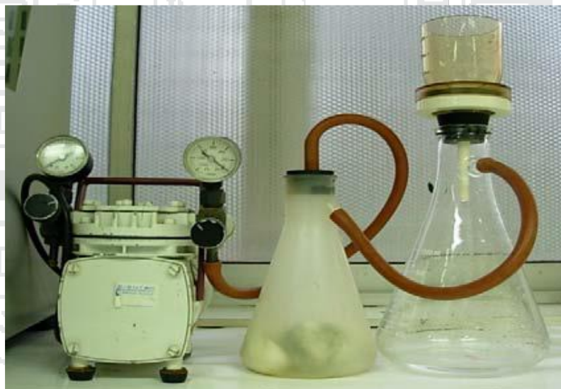
FIGURA 27 Sistema de filtrado
