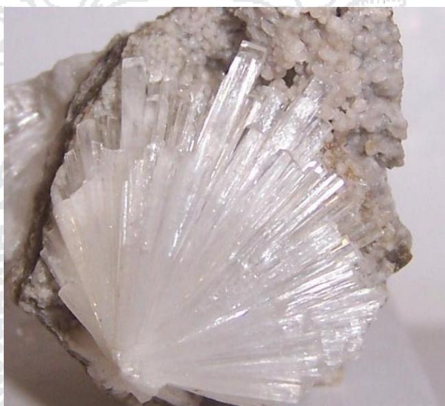
Las zeolitas son sólidos microporosos con una estructura cristalina bien definida. La unidad constructora básica es el tetraedro  $TO_4$  (donde  $T=Si, Al, B, Ga, Ge, P...$ ) cuya unión tridimensional a través de los átomos de oxígeno da lugar a la estructura poliédrica típica de las zeolitas.
