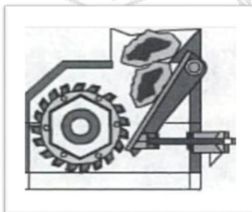
Figura 12 Trituradora de rodillos con un solo cilindro
