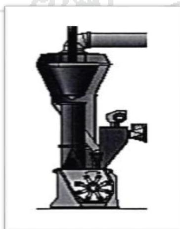
Figura 13 Esquema básico de un molino de martillos
