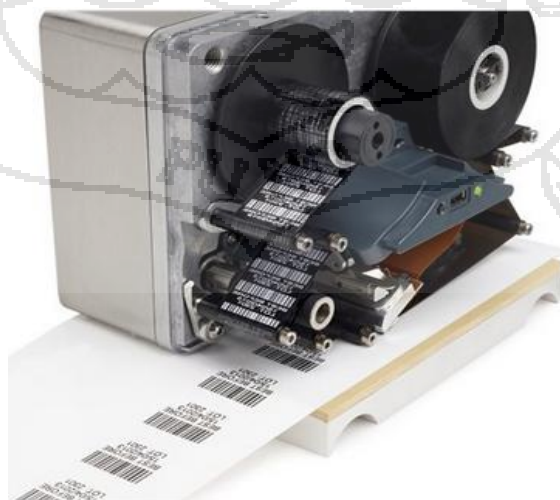
Figura 2.8: Sistema de impresión por termo-transferencia
