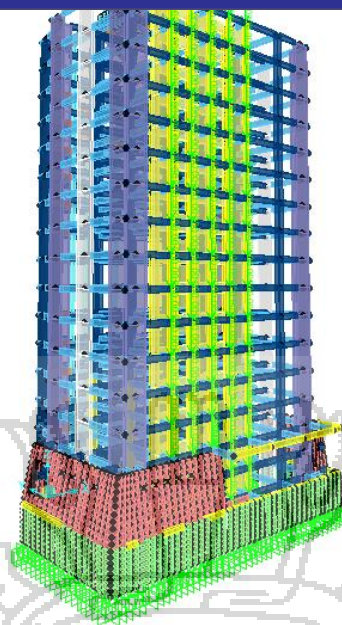
Figura 31 Modelo estructural del edificio "15 pisos".
