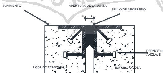
Figura III-6 Junta de Dilatación
