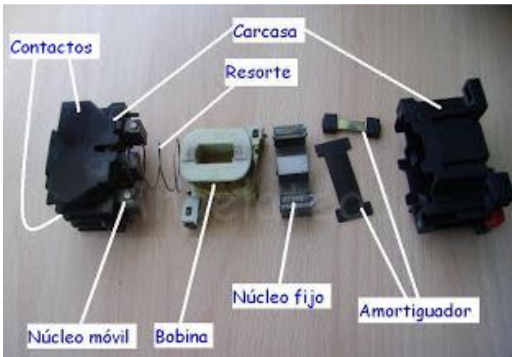
Figura N°3.9: Partes de un contactor.
