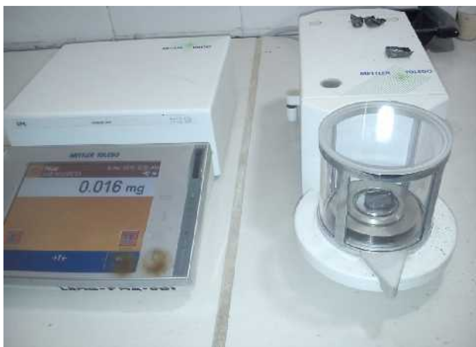
Foto 09: Pesando el botón de oro en balanza digital
