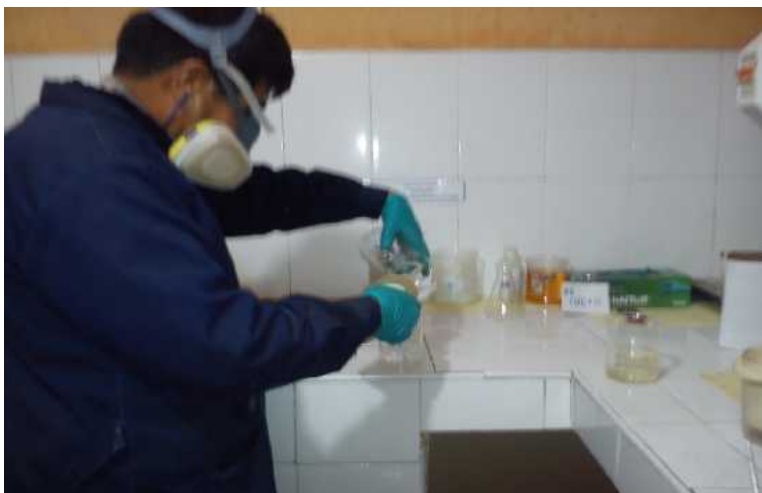
Foto 02: Separación de la resina del agua durante dos días.
