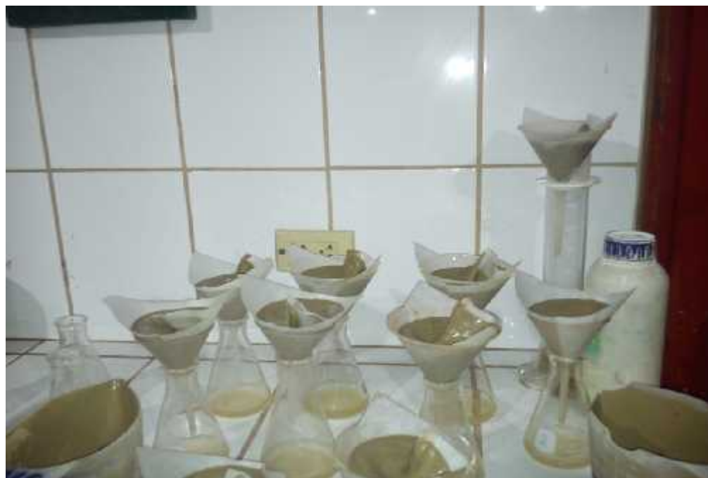
Foto 01: Filtración de pulpa del tanque de lixiviación
