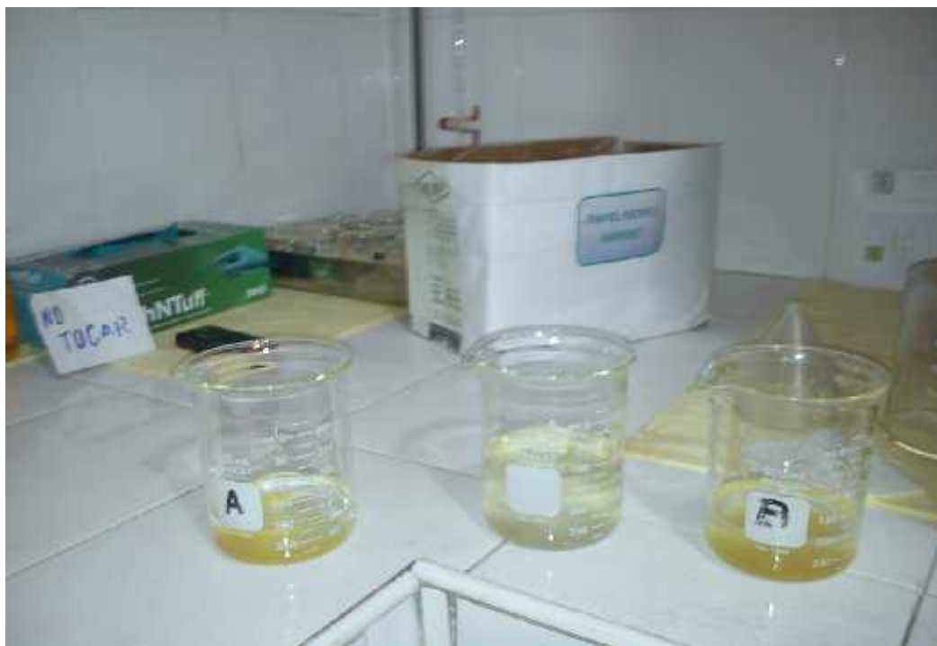
Foto 03: Son tres muestras con la solución cianurada y la resina IRA 400
