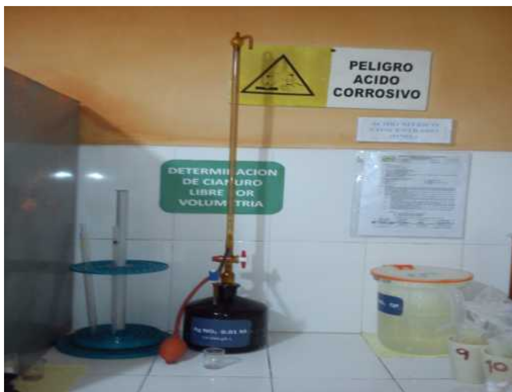
Foto 08: Titulación con \text{AgNO}_3 para la determinación de porcentaje de cianuro
