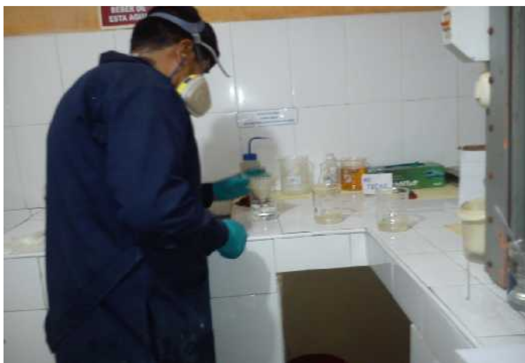
Foto 04: Filtración de la solución y la resina que estaba durante 24 horas.
