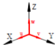
Figura 14 Sistemas de coordenadas coincidentes
