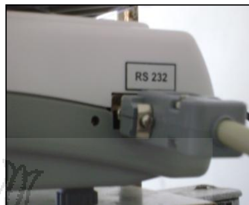
Imagen 7 . Puerto RS-232 de la balanza control de peso.
