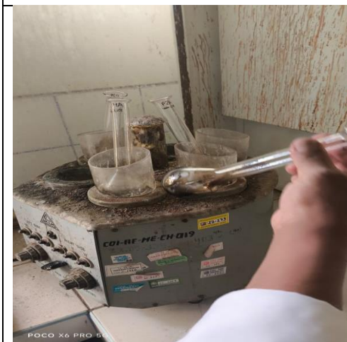
Figura 11.9. Proceso de digestión de las muestras en equipo Cocina de digestión.
