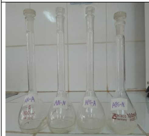
Figura 9.5.1. Almidones gelatinización de dos almidones de variedades de mashua con NaOH y etanol.
