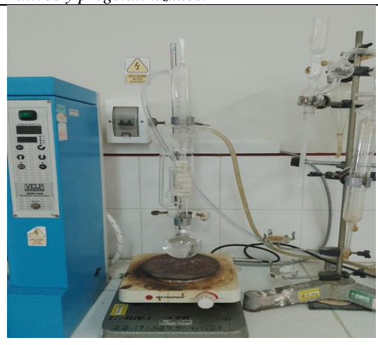
Figura 9.8. Equipo soxhlet par determinación de grasa en los almidones.
