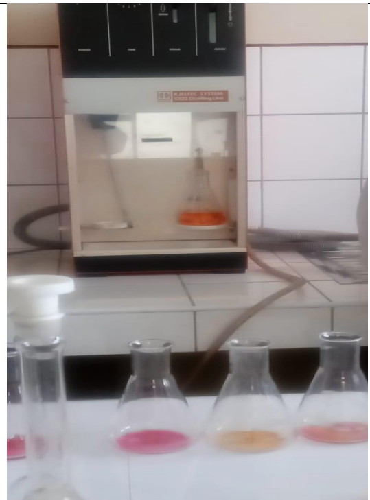
Figura 9.9.5 Determinación de proteínas de los almidones nativos y pregelatinizados.
