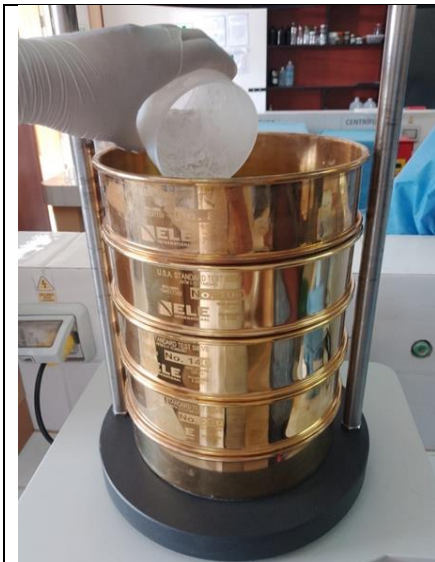
Figura 9.4. Determinación de tamaño de partícula mediante el tamizador Ro-Tap.
