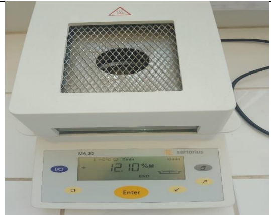
Figura 9.6. Equipo balanza de humedad para la determinación de humedad en los almidones nativos y pregelatinizados.
