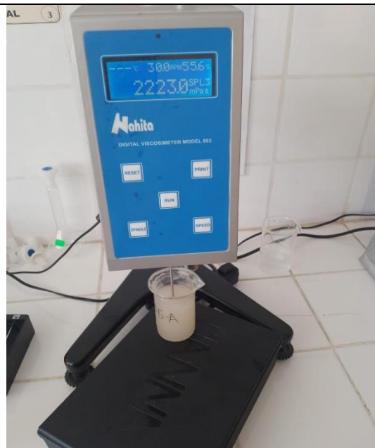
Figura 9.20. Equipo viscosímetro, lecturas del dial del torque.
