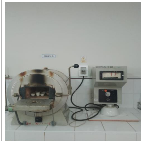
Figura 9.7. Equipo mufla para la determinación de cenizas de los almidones.
