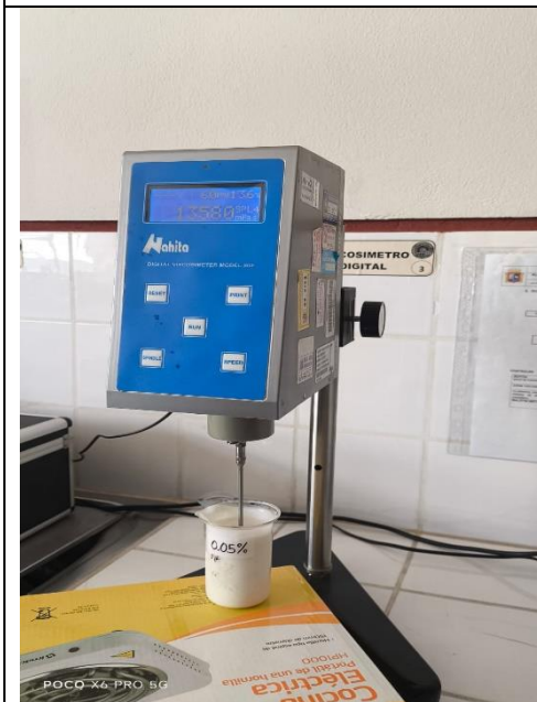
Figura 9.19. Equipo viscosímetro, mediciones de viscosidad de dos variedades de mashua.
