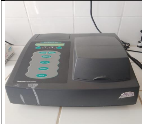
Figura 9.5.6. Equipo espectrofotómetro para lecturas de absorbancia y determinación de amilosa.
