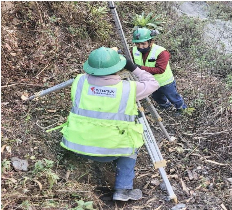
Fotografía 5. Control de la subsidencia en el túnel entrada con el nivel topográfico
