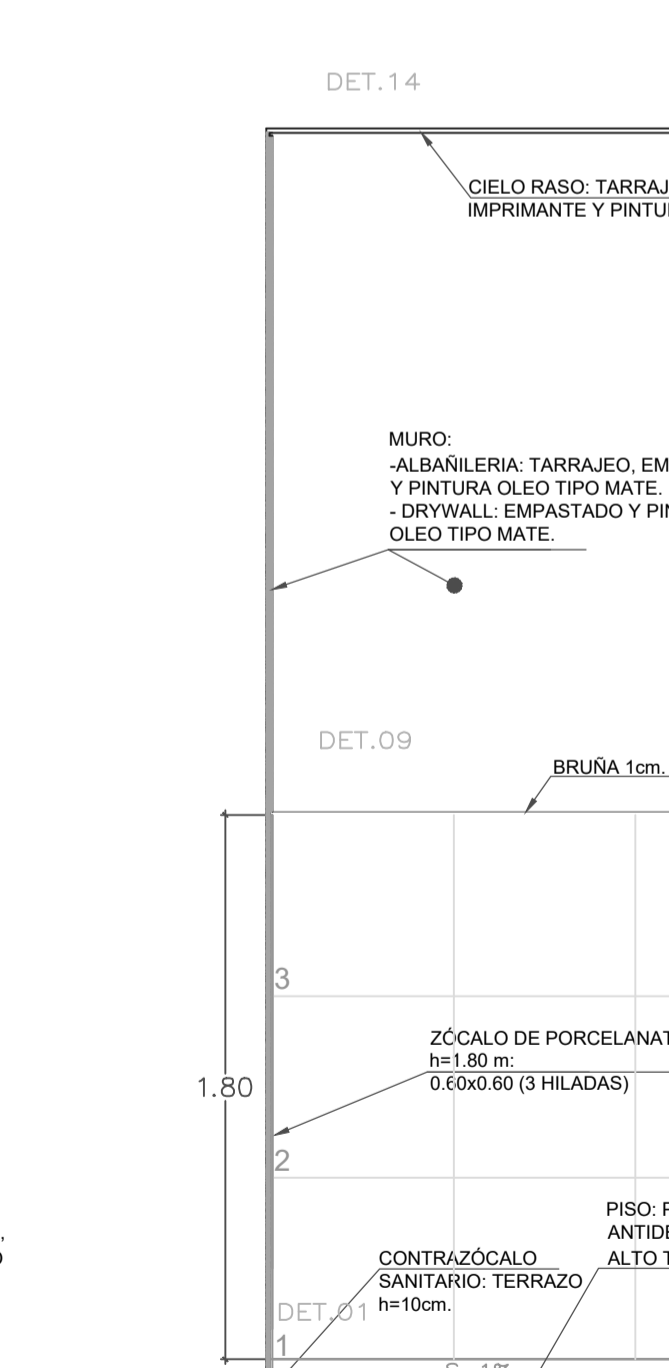
DETALLE DE ACABADO DE LAVADO DE COCHES - COMEDOR- COCINA-LAVADO DE VAJILLA-ENTREGA DE ALIMENTOS
