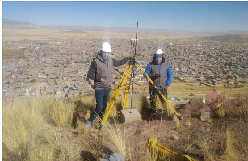
En el punto de control geodésico ITA-01, como se puede observar en la figura 3, se colocó el receptor GNSS SOUTH Modelo GALAXY G6, con número de serie SG61B1126376667EDD, y en el punto de control
