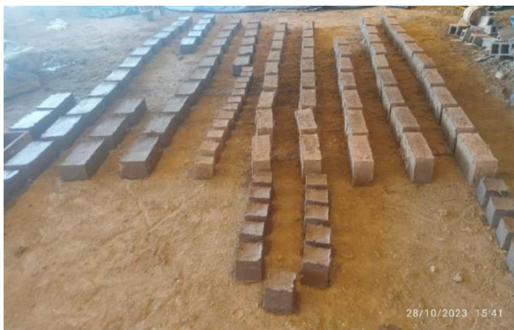
ANEXO 12. Unidades de adobe tradicional con 1.5% de fibra de polipropileno
