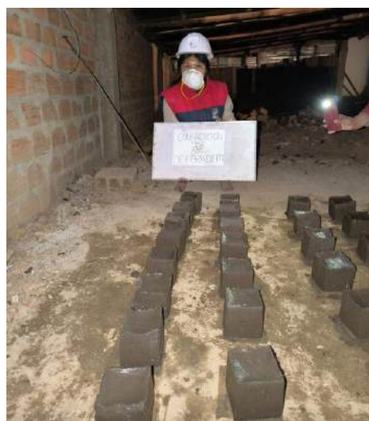
ANEXO 13. Unidades de adobe tradicional con 3.0% de fibra de polipileno
