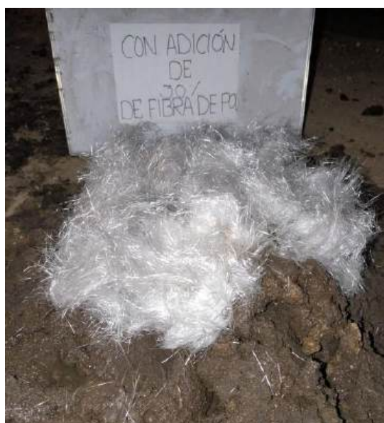
ANEXO 13. Unidades de adobe tradicional con 3.0% de fibra de polipileno
