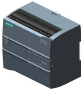
\*\*\* Repuesto \*\*\* SIMATIC S7-1200, CPU 1214C, CPU compacta DC/DC/relé, E/S INTEGRADAS: 14 DI 24 V DC; 10 DO, relé 2 A; 2 AI 0-10V DC, alimentación: AC 20,4-28,8V DC, Memoria de programas/datos 75 KB
