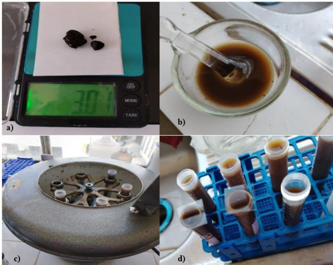
Nota: a) Pesado de muestra en balanza digital, b) Dilución de la muestra con agua destilada en mortero, c) Muestras colocadas en tubos de ensayo para la posterior centrifugación de 1,500 rpm durante 3 minutos, d) Muestras centrifugadas, se realizó la eliminación del sobrenadante, se agregó solución saturada hasta completar el menisco y se colocó la lámina cubre objeto para la adherencia de huevos de nematodos y cestodos
