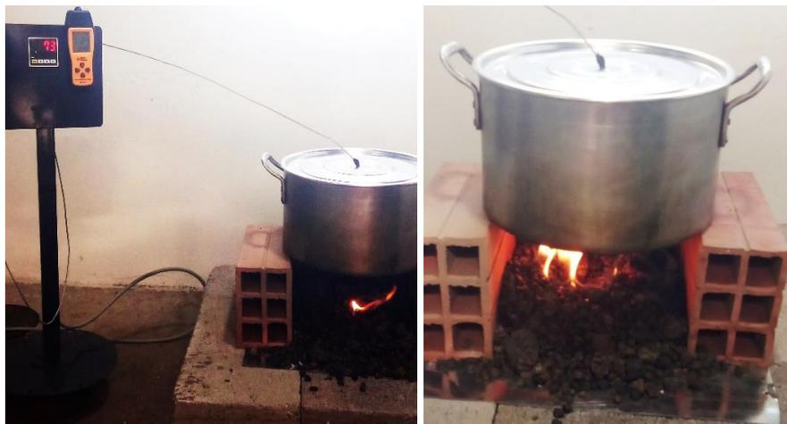
Nota: en la figura se muestra la prueba de ebullición del agua a la cocina tradicional utilizando bosta de vaca, la fotografía se tomó en pleno funcionamiento, donde se puede ver la producción de humo.
