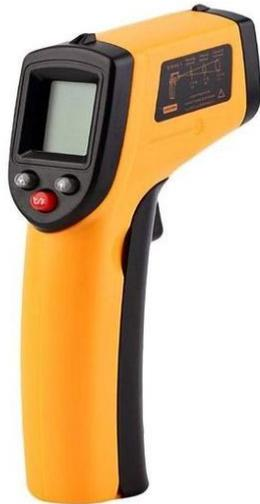
Nota: en la imagen se puede apreciar el pirómetro de infrarrojo que se utilizó para medir temperaturas en las superficies.
