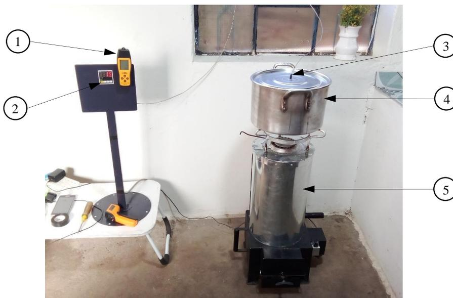
Nota. 1: Medidor de monóxido de carbono. 2: Lector de temperatura. 3: Termocupla tipo k. 4: Recipiente de agua. 5: Cocina modelo final.
