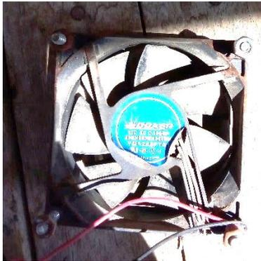
Nota: en la figura se aprecia el ventilador utilizado para el prototipo experimental de dimensiones 80x80x25mm de 12VDC marca BOXER modelo YM1208PTS1 de 7 Aspas
