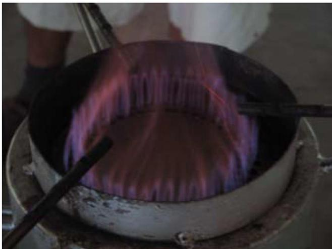
Nota: en la imagen se aprecia la combustión del gas de síntesis de la cascarilla de arroz en el quemador diseñado por Belonio mostrado en la Figura 28, el color de la llama es azulada con zonas anaranjadas lo que indica una combustión eficiente. Fuente: Tomado de Belonio (2005)
