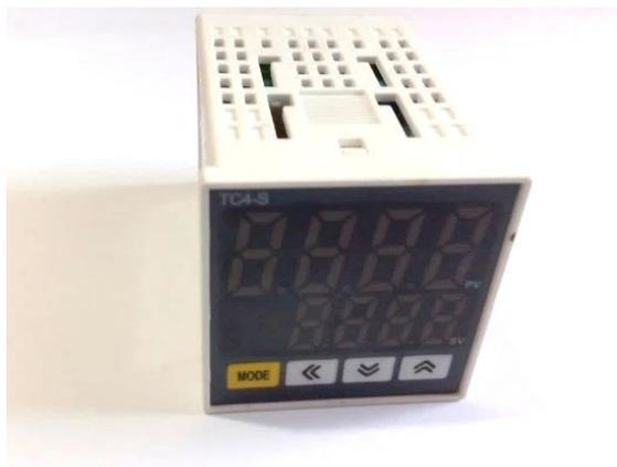
Nota: la figura muestra el pirómetro utilizado durante las pruebas experimentales. Para medir las señales de la termocupla tipo K.
