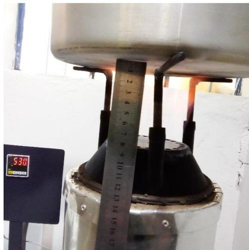
Nota: en la figura se aprecia la determinación experimental de la altura a la que debe estar la olla en el quemador “d”, se puede ver en la figura que esta altura debe estar aproximadamente a 85 mm.
