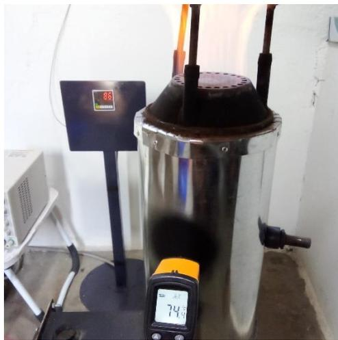
Nota: en figura se aprecia la temperatura máxima registrada durante las pruebas experimentales, se pintó de color negro la cobertura de chapa galvanizada para aumentar la precisión en la lectura.
