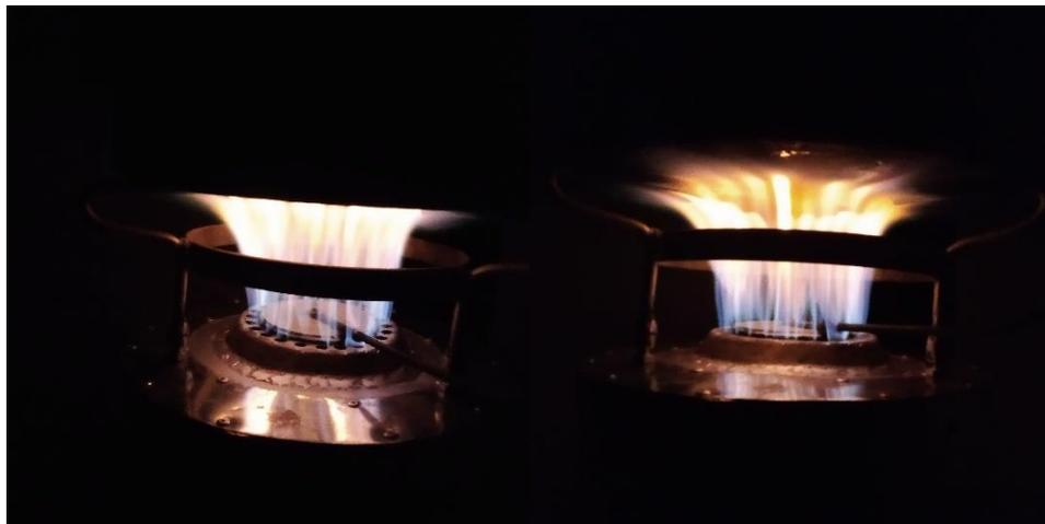
Nota: En la figura se aprecia el color del fuego de la combustión del gas de la bosta de alpaca, tomado en un fondo oscuro, ver ANEXO 9.
