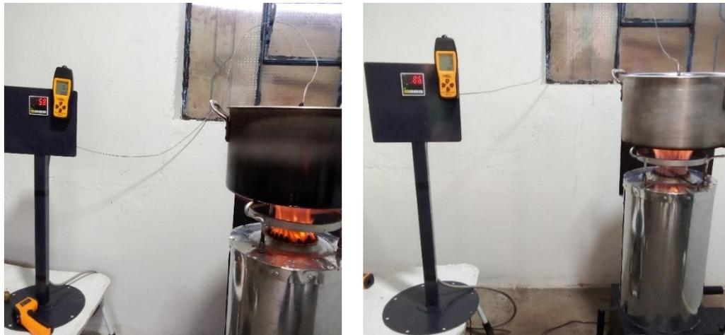
Nota: en la figura se muestra fotografías tomadas en la prueba de ebullición de agua en pleno funcionamiento de la cocina. En la izquierda se muestra la cocina utilizando bosta de vaca y en la derecha utilizando bosta de alpaca.
