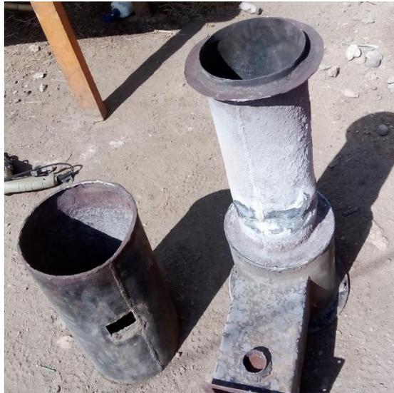
Nota: en la figura se muestra el desgaste de una cocina gasificadora TLUD durante un año con una frecuencia de uso de 4 veces por semana, en el cual se puede visualizar el deterioro por efectos de la oxidación y deformaciones por tensiones térmicas por las elevadas temperaturas.
