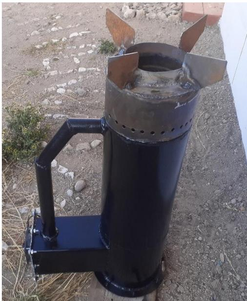
Nota: en la figura se aprecia una cocina gasificadora construida completamente de acero al carbono, en base a las medidas dadas por Belonio (2005) (solo reactor y quemador cumplen las dimensiones dadas por Belonio), el cual utiliza cenizas de biomasa como aislamiento térmico.
