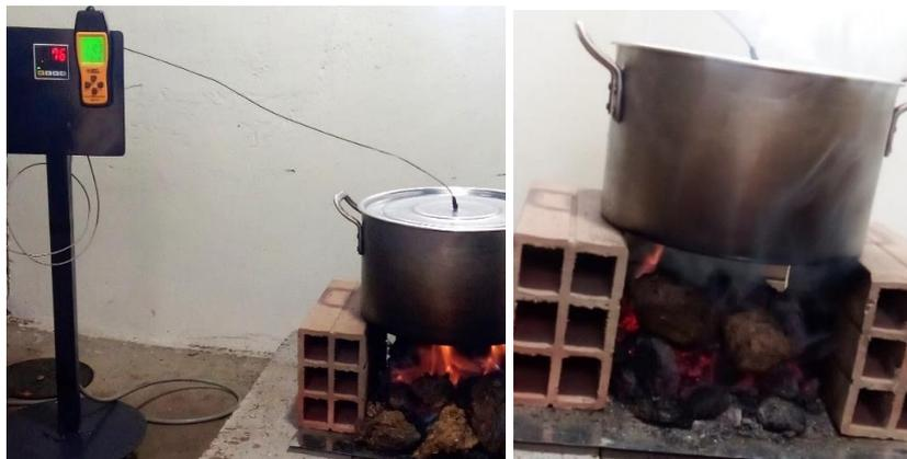
Nota: en la figura se muestra la prueba de ebullición del agua a la cocina tradicional utilizando bosta de vaca, la fotografía se tomó en pleno funcionamiento, donde se puede ver la producción de humo.
