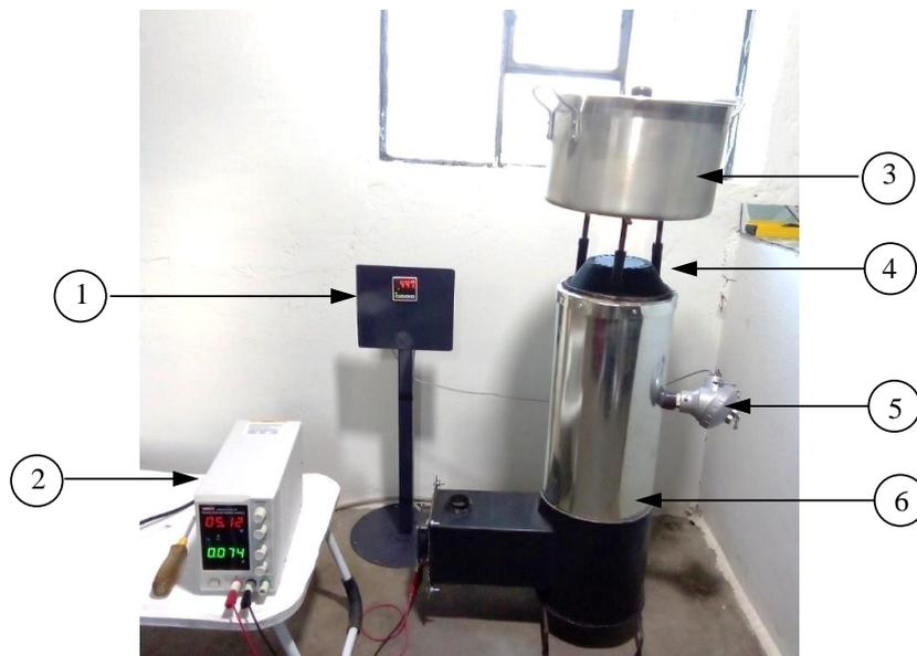
Nota: en la figura se muestra los implementos para evaluar el desempeño del prototipo experimental. Donde: (1) es el lector de temperatura (Pirómetro TC4-S) conectado a la termocupla tipo K (5) mediante un cable de extensión tipo K, (2) es la fuente de alimentación del ventilador, (3) recipiente u olla para hervir agua, (4) quemador de gas de síntesis y (6) es el reactor experimental.
