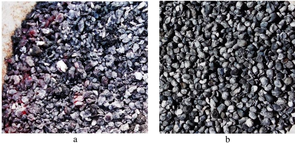
Nota: en la figura se muestra el biocarbón como producto residual de la gasificación de la biomasa en la cocina TLUD. Donde, a: biocarbón de bosta de vaca y b: biocarbón de bosta de alpaca.
