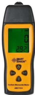
Nota: en la figura se muestra el medidor de monóxido de carbono que se utilizó para medir los niveles de concentración de monóxido de carbono durante las pruebas experimentales.
