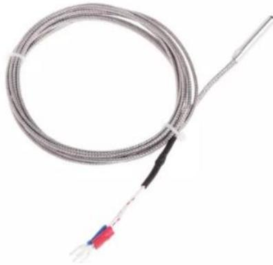
Nota: la figura muestra la termocupla tipo K que se utilizó para monitorear la temperatura del agua en las pruebas de ebullición del agua.
