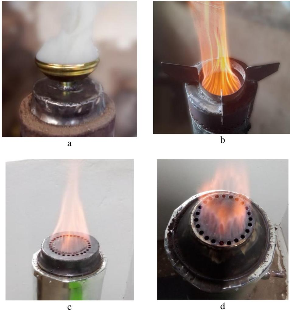
Nota: en las figuras se aprecian la combustión del gas de síntesis en los quemadores preliminares, probados con el gas proveniente de la gasificación de bosta de alpaca.
