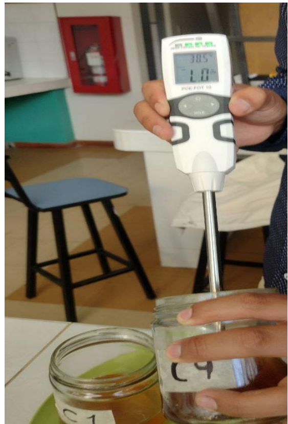
Medición de los compuestos polares totales en las muestras de pollerías y chicharronerías.
