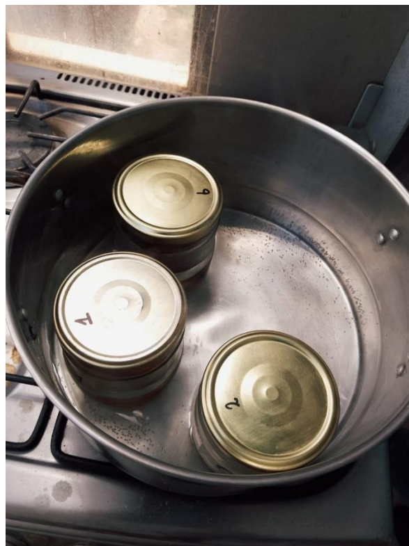
Muestras sometidas a baño maría para la conversión del estado sólido a líquido de la manteca.
