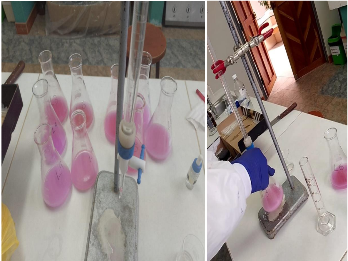
Titulación para determinar el Índice de Acidez
