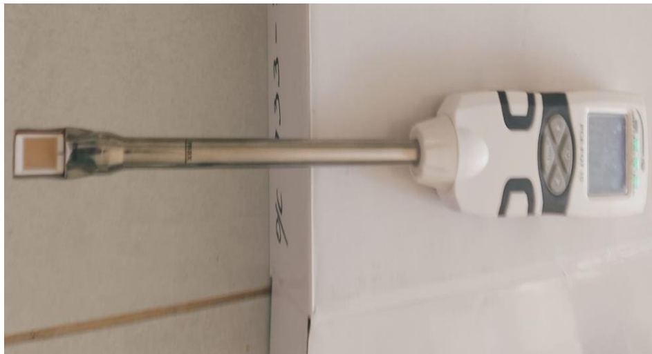
Tester Medidor de compuestos polares PCE-FOT 10
