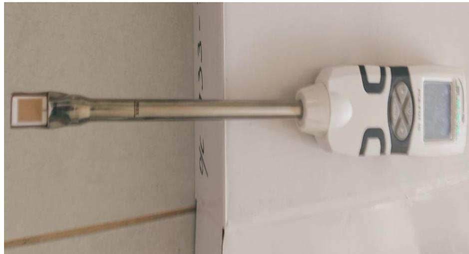
Tester Medidor de compuestos polares PCE-FOT 10
