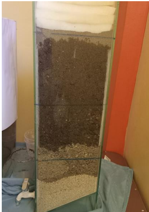
Fotografía 5: Acondicionamiento del biofiltro
