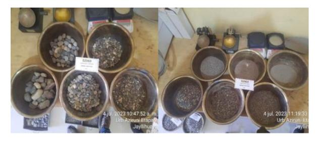
Para el agregado grueso desmonte minero, se realizó el mismo procedimiento hasta obtener pesos de cada tamiz.
