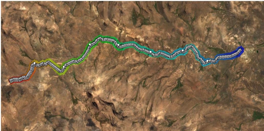
Finalizado el levantamiento fotogramétrico, se ha obtenido 1358 cámaras, total área cubierta 0.0667 km<sup>2</sup>.
