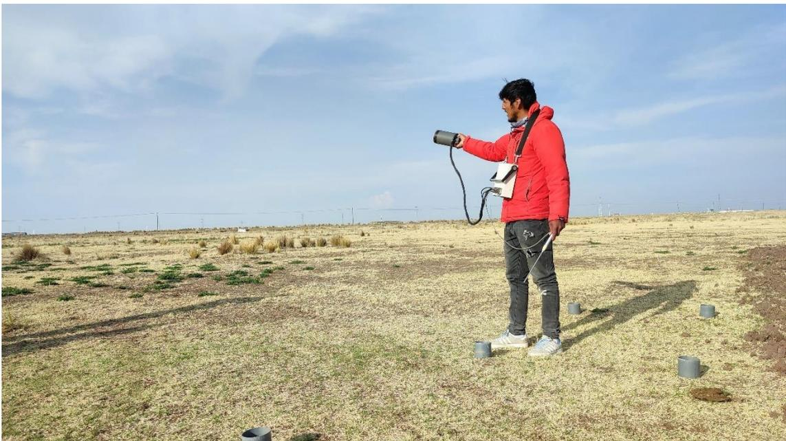
Medición de concentración de CO<sub>2</sub> en suelo sin roturar
