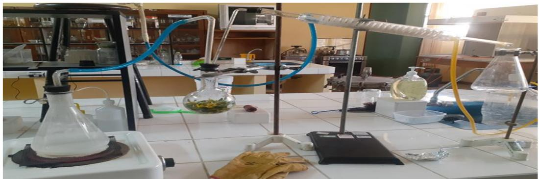
Nota: la imagen muestra un equipo de destilación compuesto por una cocinilla eléctrica, un matraz de destilación, un balón de vidrio, un condensador y un matraz colector.
