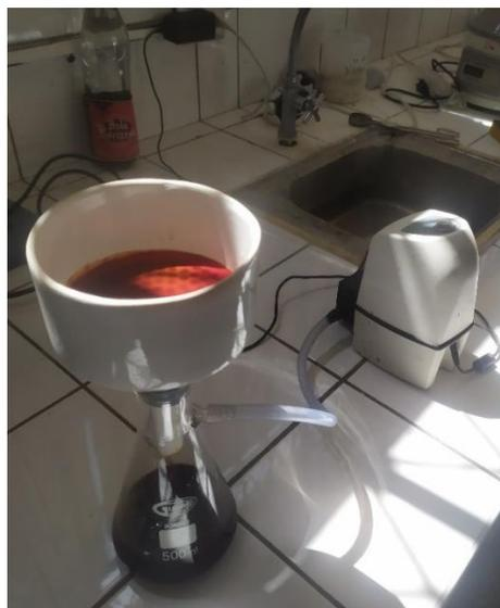
Nota: La filtración de la solución se realizó por succión con un embudo de Büchner
