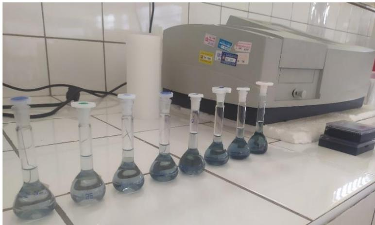
Nota: Para la curva patrón de ácido gálico se hizo una disolución concentrada de 240 mg/L, que al final se lectura la absorbancia en un espectrofotómetro UV.
