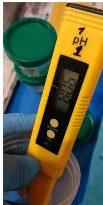
**Figura 13:** Calibración de pH metro digital con soluciones calibradoras.
