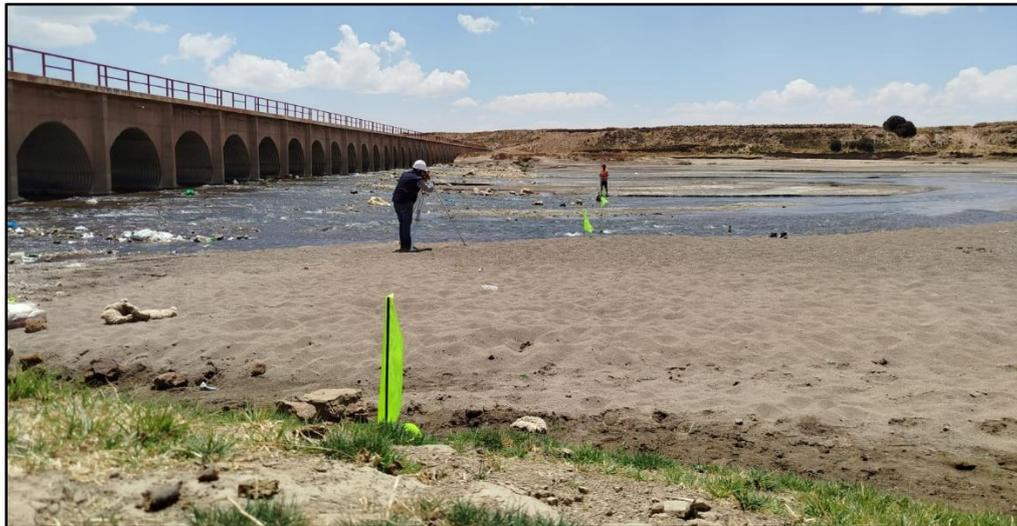
Nota: Trabajos de nivelaciones para determinar las secciones transversales
