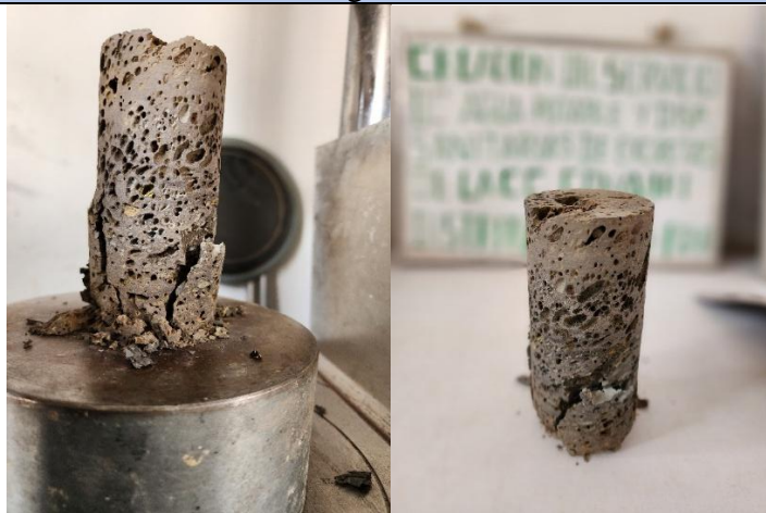
Descripción: Ensayo de compresión uniaxial en roca intacta.
