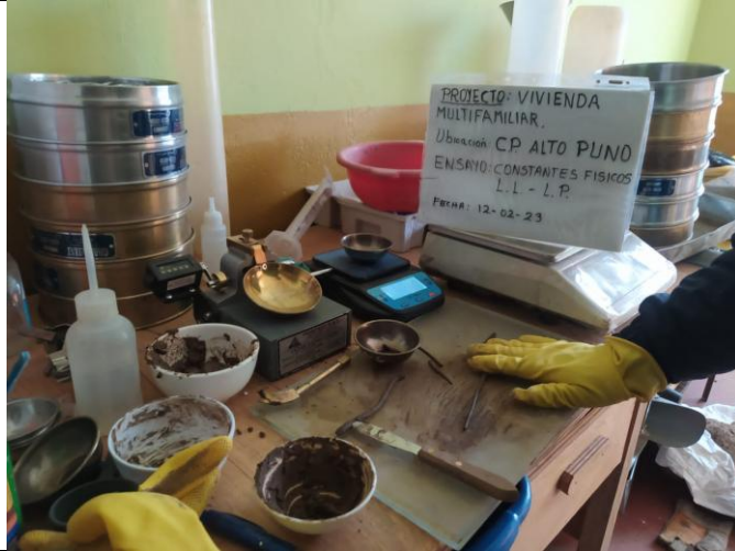
Descripción: Ensayo para determinar el límite plástico.
