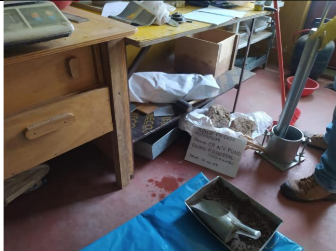
Descripción: Ensayo de Proctor modificado en material de suelo.
