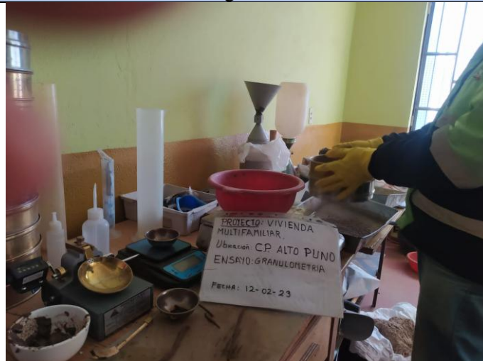
Descripción: Ensayo de granulometría en suelo mediante cribado de mallas.
