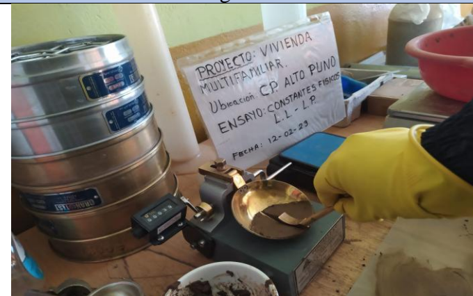
Descripción: Ensayo para determinar el límite líquido.
