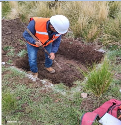
Descripción: Excavación de calicata en material de suelo, hasta llegar a la roca madre.
