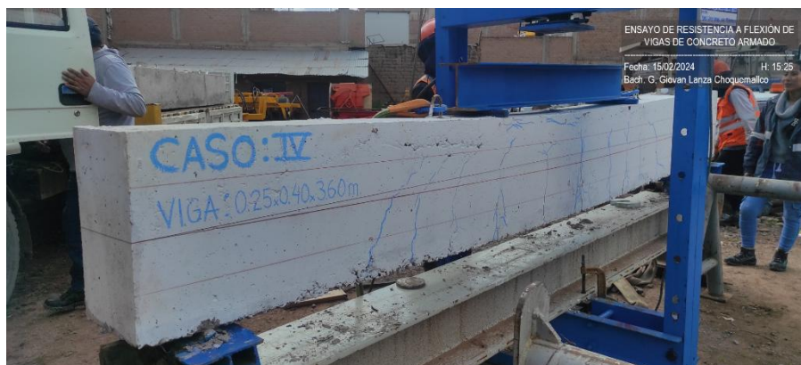
Fotografía 20: Ensayo de resistencia a flexión y fisuras de vigas de concreto armado para el Caso IV.
