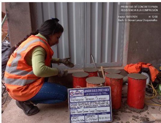
Fotografía 08: Preparación de seis probetas de concreto para la verificación de resistencia del concreto.
