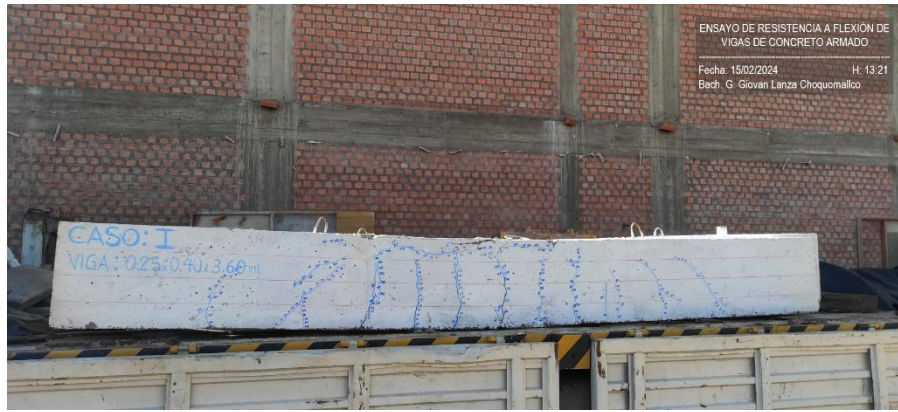
Fotografía 21: Ensayo de resistencia a flexión y fisuras de vigas de concreto armado para el Caso I.
