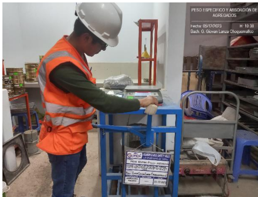
Fotografía 02: Ensayos de caracterización, peso específico y absorción de los agregados – cantera Isla
