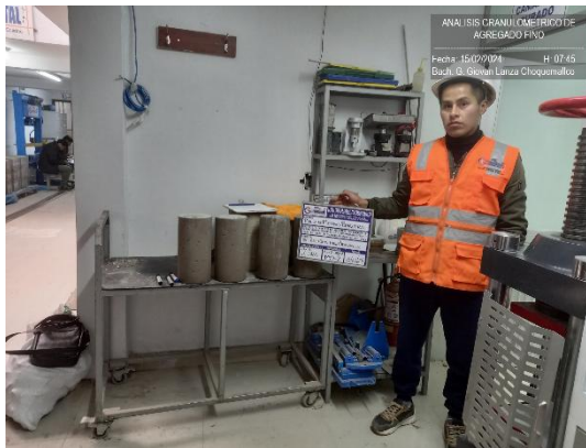
Fotografía 11: Ensayos de rotura de probetas de concreto para verificar la resistencia a la compresión.
