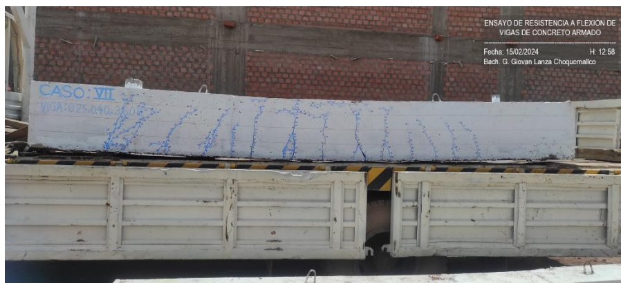
Fotografía 24: Ensayo de resistencia a flexión y fisuras de vigas de concreto armado para el Caso VII.
