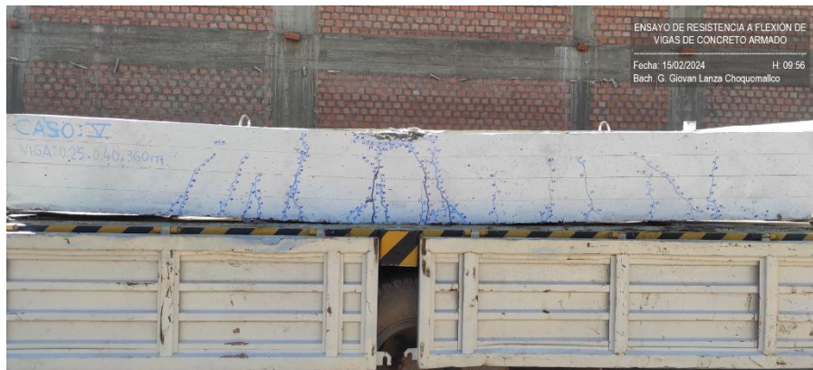
Fotografía 18: Ensayo de resistencia a flexión y fisuras de vigas de concreto armado para el Caso V.
