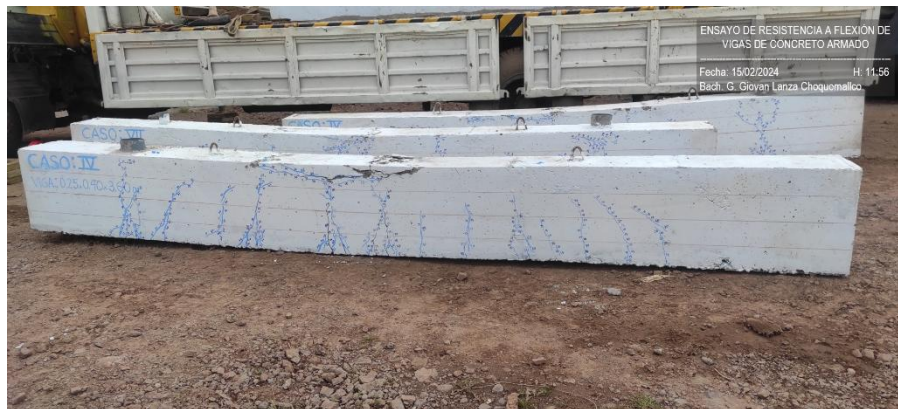
Fotografía 14: Ensayo de resistencia a flexión y fisuras de vigas de concreto armado para el Caso IV.
