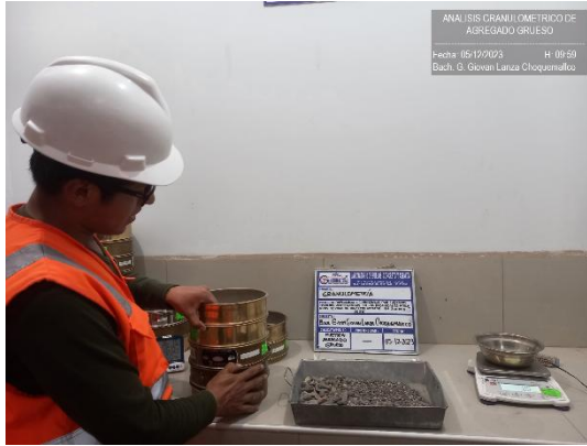
Fotografía 01: Ensayos de caracterización, análisis granulométrico de los agregados – cantera Isla.
