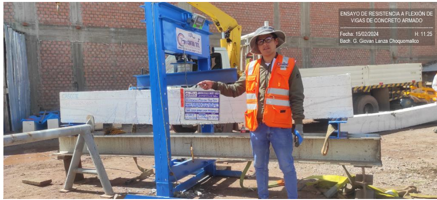
Fotografía 13: Ensayo de resistencia a flexión y fisuras de vigas de concreto armado para el Caso II.
