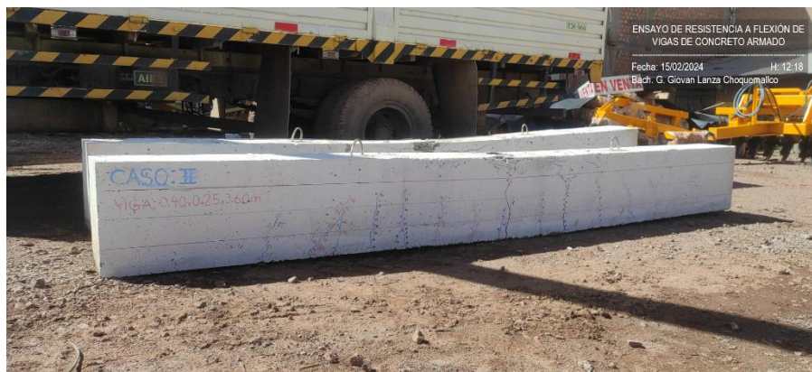
Fotografía 23: Ensayo de resistencia a flexión y fisuras de vigas de concreto armado para el Caso II.
