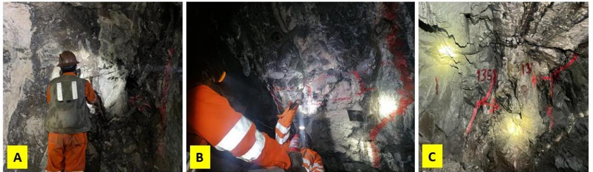
A) Identificación de estructuras y delimitación. B) Muestreo sistemático a cada 2 metros. C) Codificación de muestras para su levantamiento topográfico.
