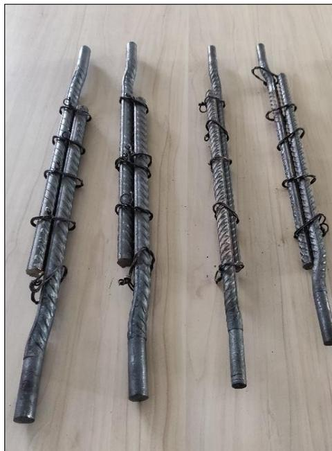
Nota: Especímenes ensayados que desarrollaron la resistencia a la tracción mediante la lectura de la carga ultima en el momento del desprendimiento del amarre del espécimen de empalme tipo II por soldadura para varillas de acero corrugado de 5/8".
