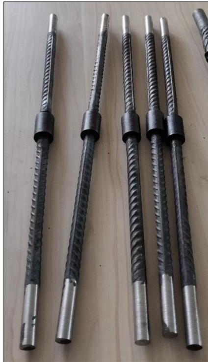
Nota: Producto de elaboración y confección de espécimen de longitud de 500 mm, para empalme tipo I por conector mecánico para varillas de acero corrugado de 1/2”, es necesario resaltar el acabado liso de los extremos con una longitud de 50 mm de tal manera las mordazas de la maquina universal de ensayo pueda sujetar uniformemente y llevar correctamente el ensayo a tracción en acero.
