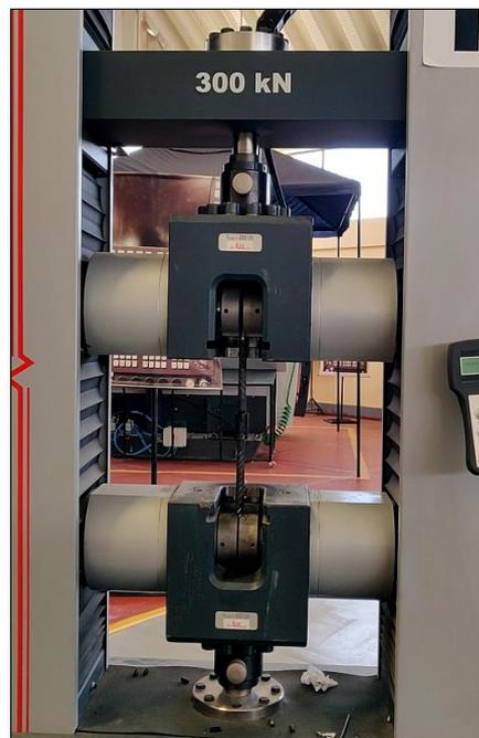
Nota: Proceso de ensayo a tracción en acero, para el espécimen de empalme tipo I por conector mecánico en varillas de acero corrugado de 3/4", velocidad de ensayo 500 mm/min. Laboratorio de ensayo de I.E.S.T.P José Carlos Mariátegui de Moquegua.
