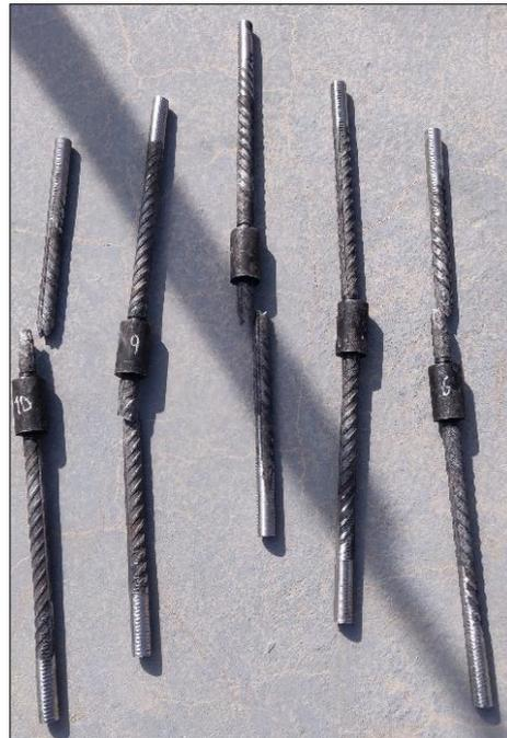
Nota: Especímenes ensayados que desarrollaron la resistencia a la tracción mediante la lectura de la carga ultima antes de la rotura del espécimen de empalme tipo I por conector mecánico para varillas de acero corrugado de 5/8".
