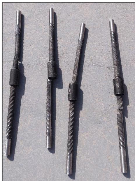
Nota: Especímenes ensayados que desarrollaron la resistencia a la tracción mediante la lectura de la carga ultima antes de la rotura del espécimen de empalme tipo I por conector mecánico para varillas de acero corrugado de 3/4"
