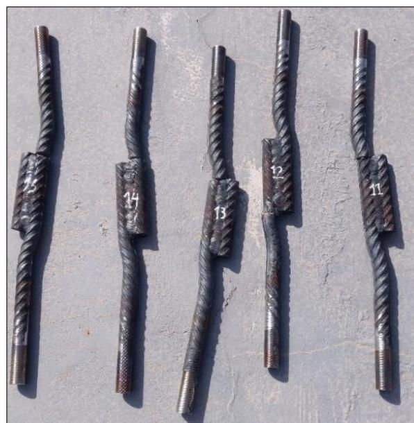
Nota: Especímenes ensayados que desarrollaron la resistencia a la tracción mediante la lectura de la carga ultima antes de la rotura del espécimen de empalme tipo III por soldadura para varillas de acero corrugado de 3/4"
