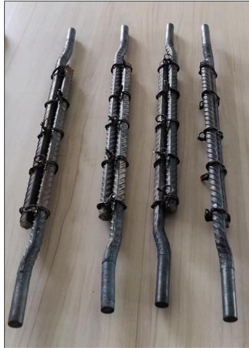
Nota: Producto de elaboración y confección de espécimen de longitud de 500 mm, para empalme tipo II por traslape para varillas de acero corrugado de 1/2", es necesario resaltar el acabado liso de los extremos con una longitud de 50 mm de tal manera las mordazas de la maquina universal de ensayo pueda sujetar uniformemente y llevar correctamente el ensayo a tracción en acero.
