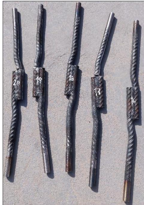
Nota: Especímenes ensayados que desarrollaron la resistencia a la tracción mediante la lectura de la carga ultima antes de la rotura del espécimen de empalme tipo III por soldadura para varillas de acero corrugado de 5/8".
