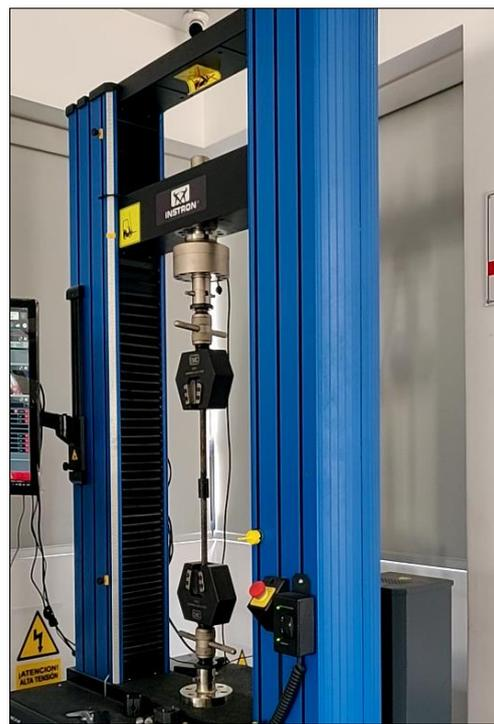
Nota: Proceso de ensayo a tracción en acero, para el espécimen de empalme tipo I por conector mecánico en varillas de acero corrugado de 1/2”, velocidad de ensayo 10 mm/min. Laboratorio de ensayo de materiales UNAS de Arequipa.
