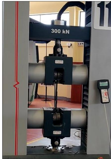
Nota: Proceso de ensayo a tracción en acero, para el espécimen de empalme tipo III por soldadura en varillas de acero corrugado de 5/8", velocidad de ensayo 500 mm/min. Laboratorio de ensayo de I.E.S.T.P José Carlos Mariátegui de Moquegua.
