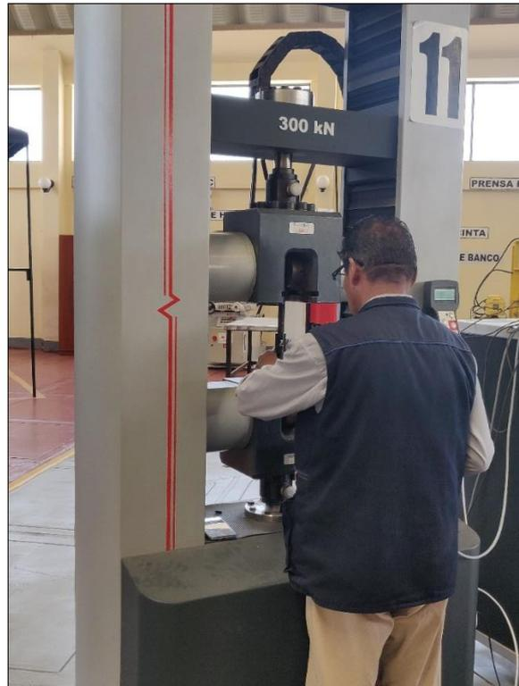
Imagen 38: Procedimiento de preparación de ensayo de tracción en acero para especímenes en maquina universal de ensayo en taller de ensayo de materiales del programa de estudios de Mecánica y Producción Industrial del Instituto de Educación Superior Tecnológica Publica José Carlos Mariátegui de Moquegua, a cargo del Mgr. Julio Modesto Laura Curasi
