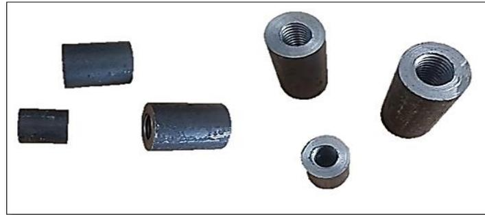
Nota: Conector mecánico elaborado de forma propia para varillas de 1/2", 5/8" y 3/4"
