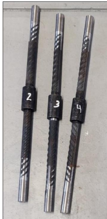
Nota: De la misma forma que el empalme tipo I por conector mecánico de la figura 23, con la diferencia que este para varillas de acero corrugado de 3/4"
