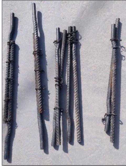
Nota: Especímenes ensayados que desarrollaron la resistencia a la tracción mediante la lectura de la carga ultima en el momento del desprendimiento del amarre del espécimen de empalme tipo II por soldadura para varillas de acero corrugado de 1/2".
