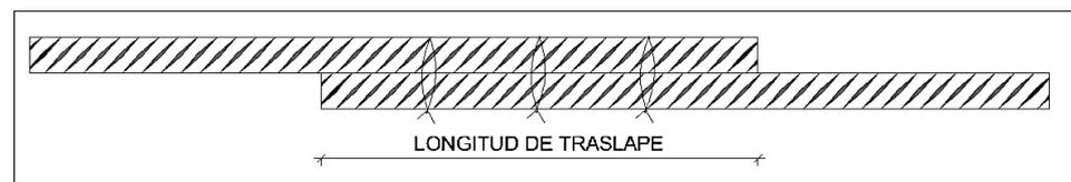
Nota: Dibujo propio de esquema de empalme por traslape entre varillas de acero corrugado mediante el amarre con alambre negro recocido calibre 16
