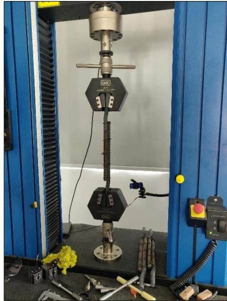
Nota: Proceso de ensayo a tracción en acero, para el espécimen de empalme tipo II por traslape en varillas de acero corrugado de 3/4", velocidad de ensayo 10 mm/min. Laboratorio de ensayo de materiales UNSA de Arequipa.
