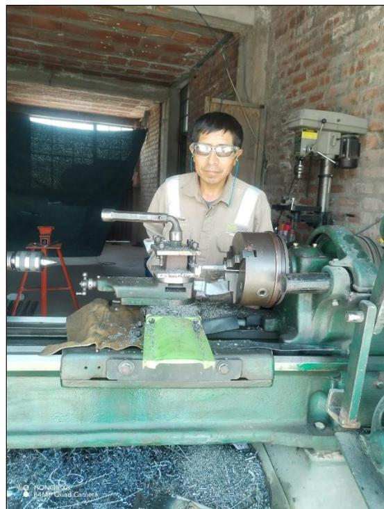
Imagen 35: Maquina de tornería en trabajos de fabricación de conector mecánico roscado y mano de obra por parte del Sr, Hernán Huayna Aquino.
