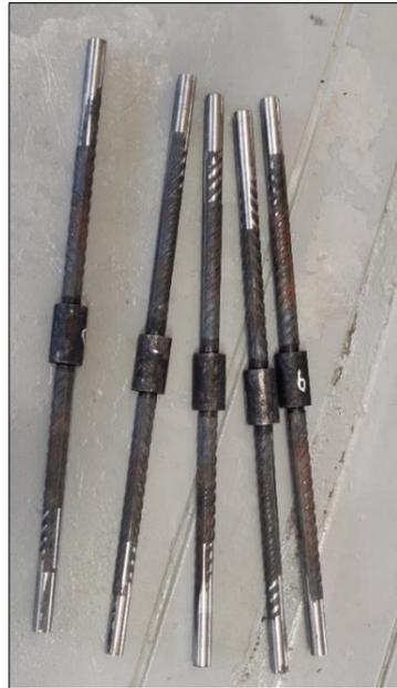
Nota: De la misma forma que el empalme tipo I por conector mecánico de la figura 23, con la diferencia que este para varillas de acero corrugado de 5/8"
