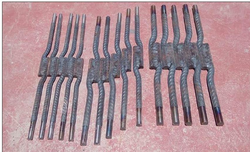
Nota: Producto de elaboración y confección de espécimen de longitud de 500 mm, para empalme tipo III por soldadura para varillas de acero corrugado de 1/2", 5/8" y 3/4", es necesario resaltar el acabado liso de los extremos con una longitud de 50 mm de tal manera las mordazas de la maquina universal de ensayo pueda sujetar uniformemente y llevar correctamente el ensayo a tracción en acero.
