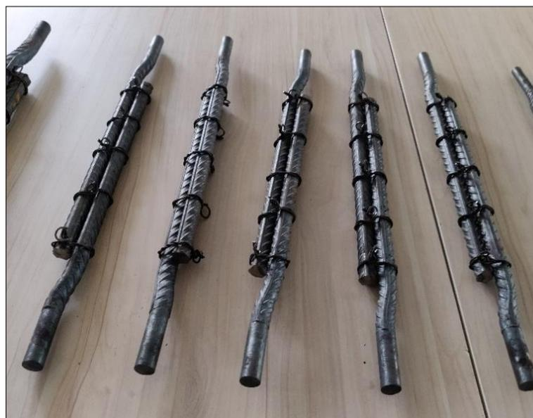
Nota: De la misma forma que el empalme tipo II por traslape de la figura 35, con la diferencia que este para varillas de acero corrugado de 5/8"
