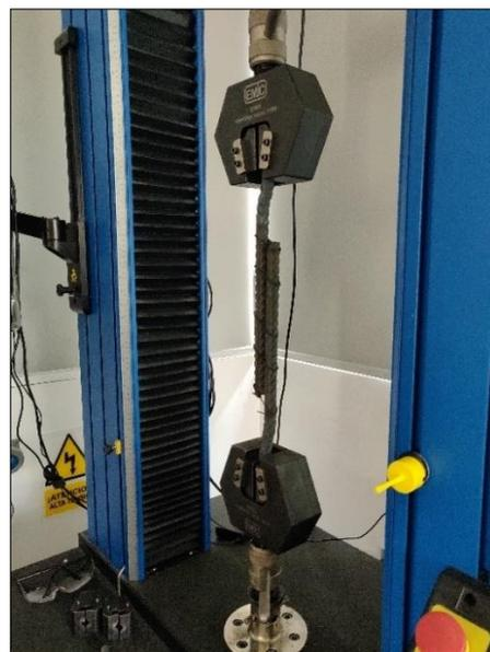
Nota: Proceso de ensayo a tracción en acero, para el espécimen de empalme tipo II por traslape en varillas de acero corrugado de 5/8", velocidad de ensayo 10 mm/min. Laboratorio de ensayo de materiales UNSA de Arequipa.
