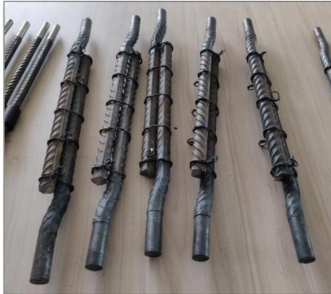
Nota: De la misma forma que el empalme tipo II por traslape de la figura 35, con la diferencia que este para varillas de acero corrugado de 3/4"
