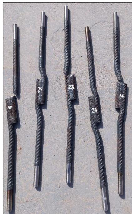
Nota: Especímenes ensayados que desarrollaron la resistencia a la tracción mediante la lectura de la carga última antes de la rotura del espécimen de empalme tipo III por soldadura para varillas de acero corrugado de 1/2"
