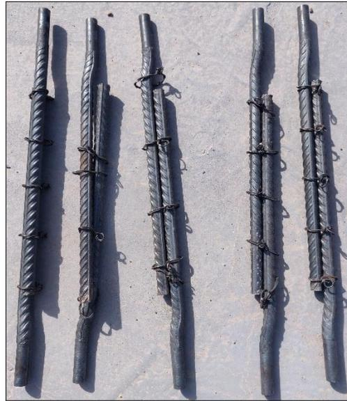
Nota: Especímenes ensayados que desarrollaron la resistencia a la tracción mediante la lectura de la carga última en el momento del desprendimiento del amarre del espécimen de empalme tipo II por soldadura para varillas de acero corrugado de 3/4".
