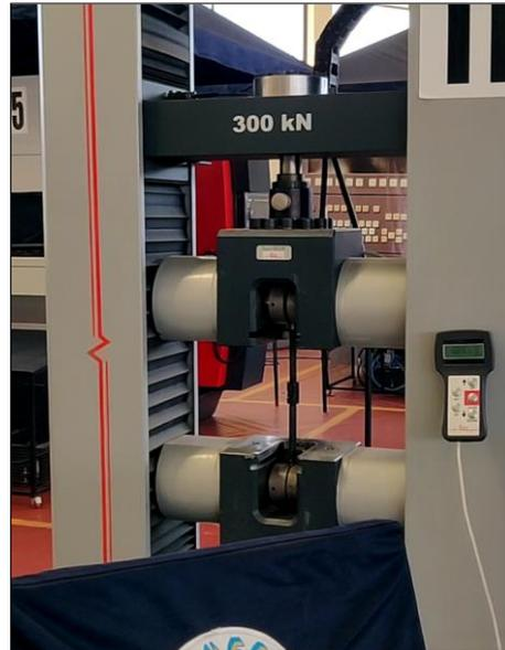
Nota: Proceso de ensayo a tracción en acero, para el espécimen de empalme tipo I por conector mecánico en varillas de acero corrugado de 5/8", velocidad de ensayo 500 mm/min. Laboratorio de ensayo de I.E.S.T.P José Carlos Mariátegui de Moquegua.
