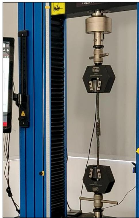
Nota: Proceso de ensayo a tracción en acero, para el espécimen de empalme tipo III por soldadura en varillas de acero corrugado de 1/2", velocidad de ensayo 10 mm/min. Laboratorio de ensayo de materiales UNSA de Arequipa.
