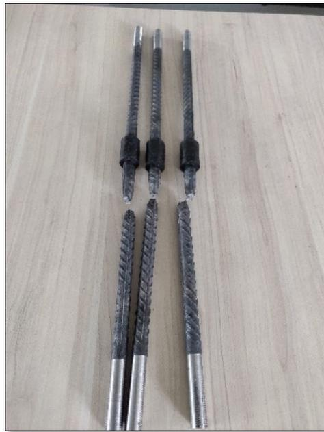
Nota: Especímenes ensayados que desarrollaron la resistencia a la tracción mediante la lectura de la carga ultima antes de la rotura del espécimen de empalme tipo I por conector mecánico para varillas de acero corrugado de 1/2".
