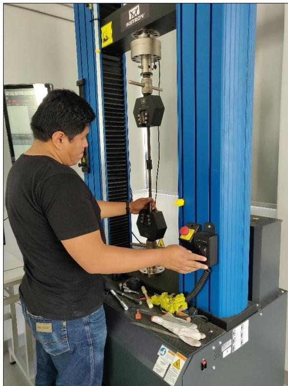
Imagen 37: Procedimiento de preparación para ensayo de tracción en acero para especímenes en maquina universal de ensayo en laboratorio de ensayo de materiales de la escuela profesional de ingeniería de materiales de la Universidad Nacional San Agustín de Arequipa, a cargo de del Dr. Elmer Mamani Calcina
