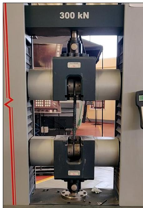
Nota: Proceso de ensayo a tracción en acero, para el espécimen de empalme tipo III por soldadura en varillas de acero corrugado de 3/4", velocidad de ensayo 500 mm/min. Laboratorio de ensayo de I.E.S.T.P José Carlos Mariátegui de Moquegua.
