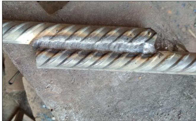
Nota: Aplicación de soldadura SMAW E7018 tipo solapado de contacto directo, para empalme tipo II por soldadura en varillas de acero corrugado.
