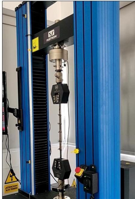
Nota: Proceso de ensayo a tracción en acero, para el espécimen de empalme tipo II por traslape en varillas de acero corrugado de 1/2", velocidad de ensayo 10 mm/min. Laboratorio de ensayo de materiales UNSA de Arequipa.
