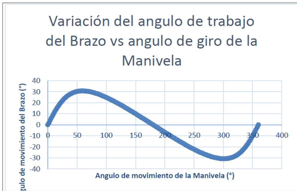
Para el cálculo del ángulo de inspiración y espiración se realiza aplicando la Ley de Senos para Triángulos Oblicuángulos, cuando el Brazo y la Manivela se encuentren de forma perpendicular (en el anterior gráfico se observa como los puntos máximos y mínimos de la curva) y teniendo una distancia de centros de 9.0 cm y para L3 con Pitágoras.
