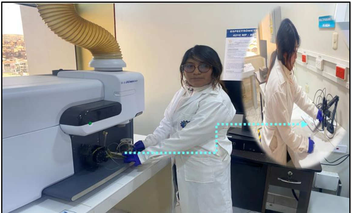
Panel Fotográfico Febrero 2024 LAB MINAS Análisis de metales pesados (As, Hg, Fe, Pb, Cd, Zn, Cu) por Espectrofotómetro de Emisión Atómica por Plasma Microondas 4210 MP-AES
