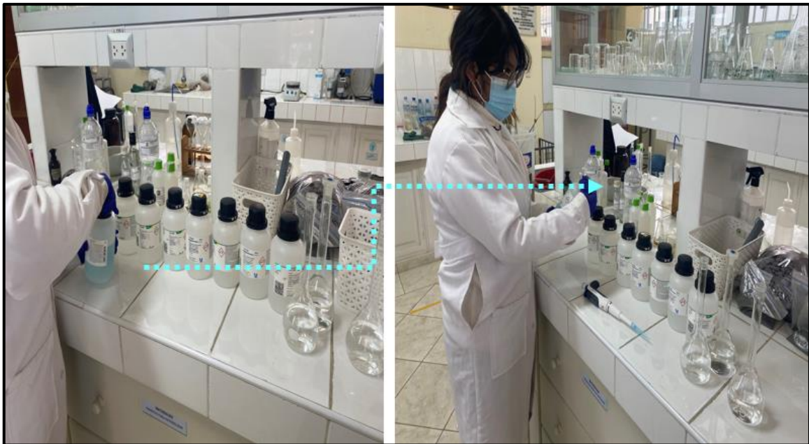
Panel Fotográfico Febrero 2024 LAB MINAS Se realizó la curva de calibración para cada metal pesados con los patrones en tres concentraciones de 2.5 ppm, 5 ppm, 10 ppm
