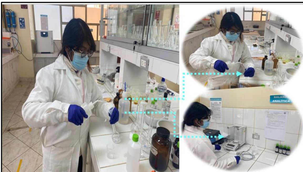
Panel Fotográfico Febrero 2023 LAB MINAS Realización la curva de calibración y el filtrado de las muestras de agua de mina para luego realizar los análisis.
