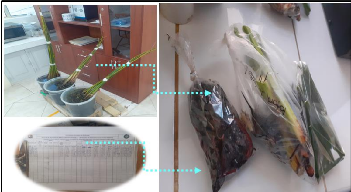
Panel Fotográfico Febrero 2024 LAB MINAS Se tomo cada uno de los parámetros registrándole en la cadena de custodia luego se congelo la muestra de la totora para luego llevarla a la liofilización.
