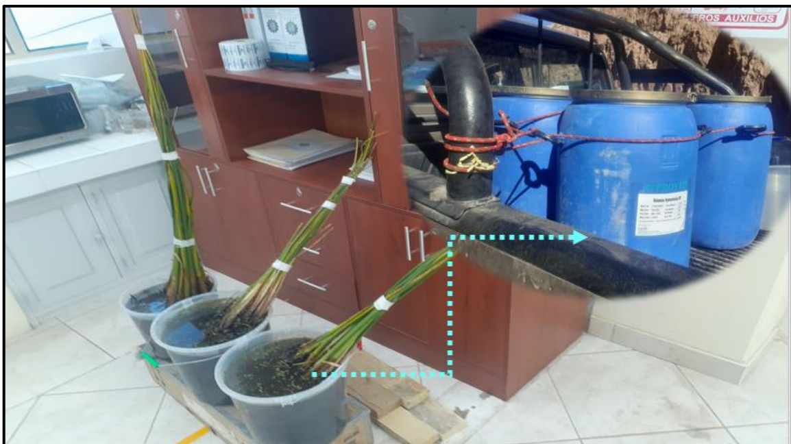
Panel Fotográfico Febrero 2024 LAB MINAS Se colocó en cada uno los baldes de agua de mina de los Rosales junto con la totora para realización de la acumulación de los pesados.
