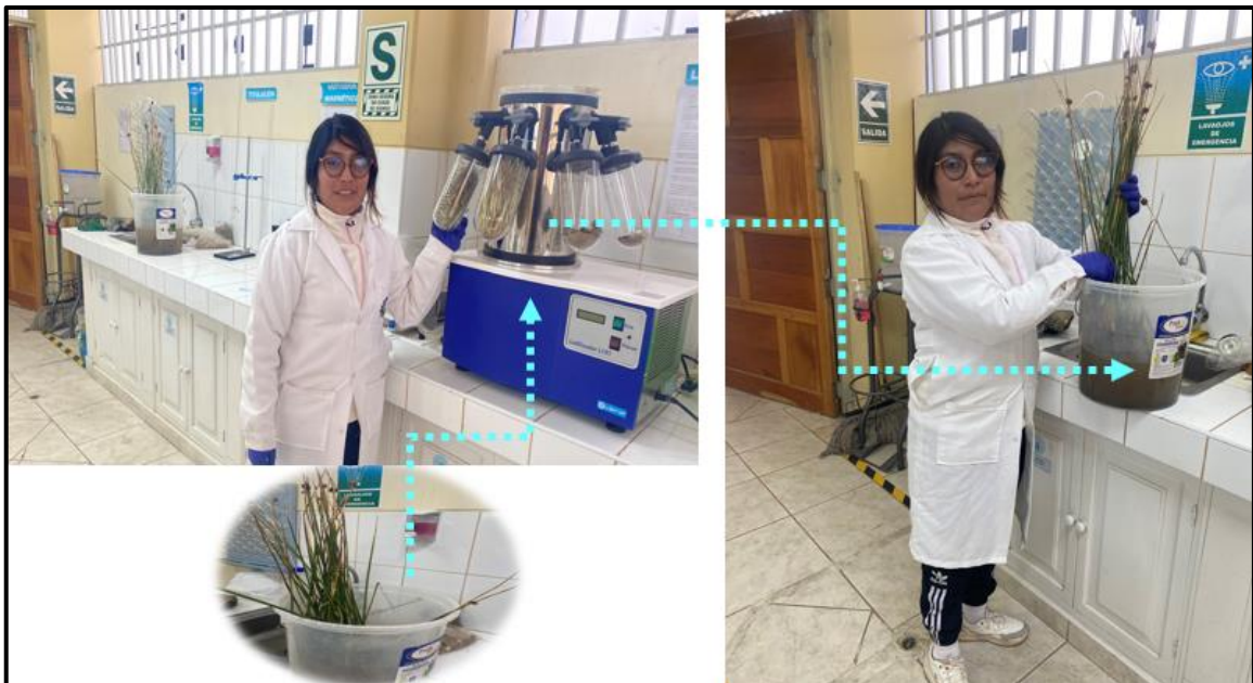
Panel Fotográfico Febrero 2024 LAB MINAS Se realizó la liofilización de la totora para luego digester sacándole toda la humedad al vacío para luego llevarla la trituradora y pulverizar separando la raíz, tallo de la totora.
