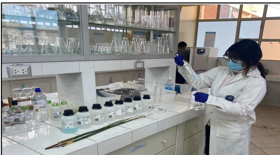
Panel Fotográfico Febrero 2024 LAB MINAS Se realizó la curva de calibración para llevarla la lectura de los metales pesados para cada uno de los patrones.
