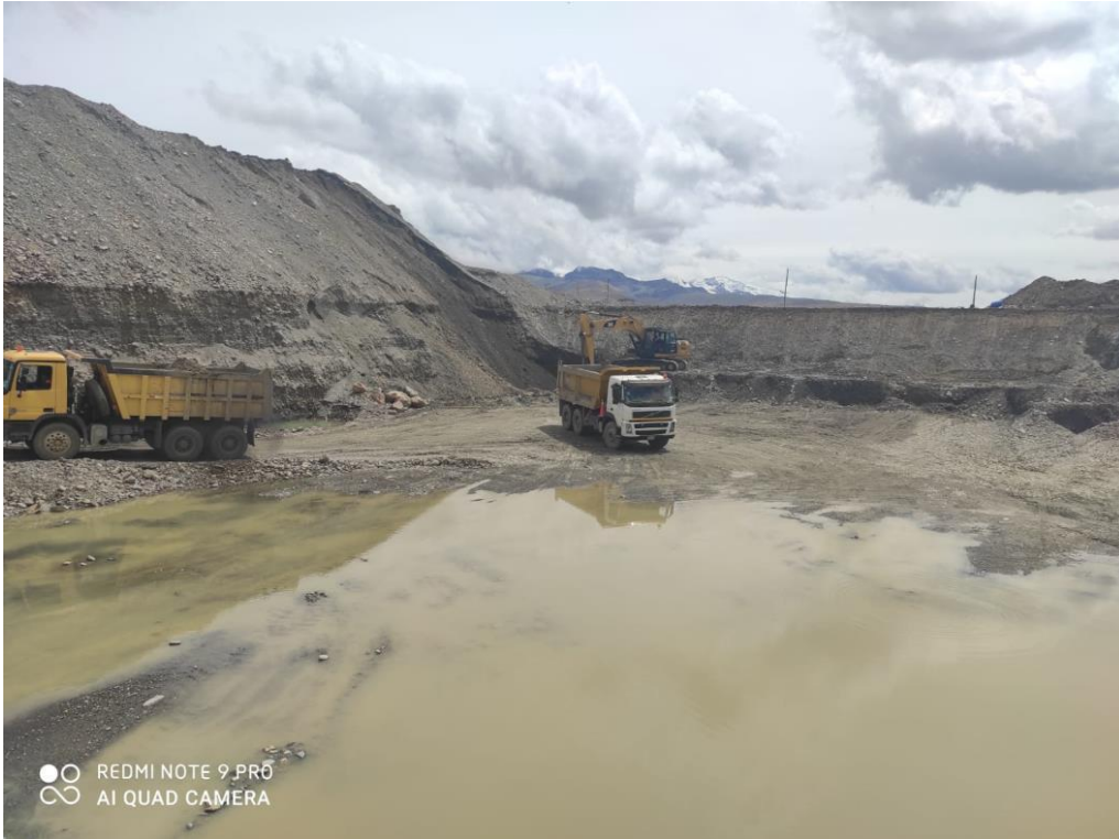
12.7 - Vista de la maquinaria como volquetes transportando el material aurífero y la excavadora extrayendo material del frente de minado.
