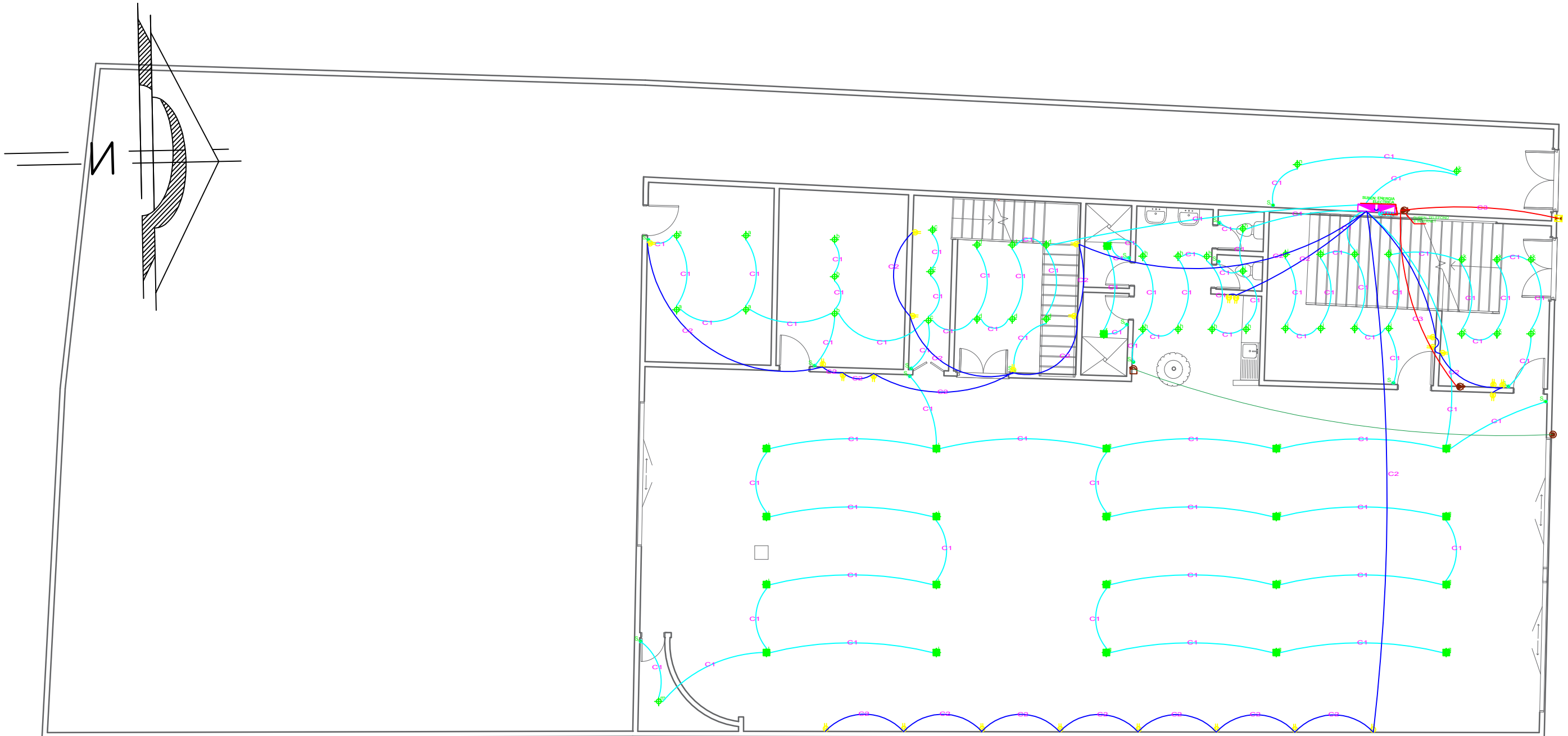
NIVEL-1 INSTALACIONES-ELECTRICAS-LUMINARIAS ESC: 1/1 25
