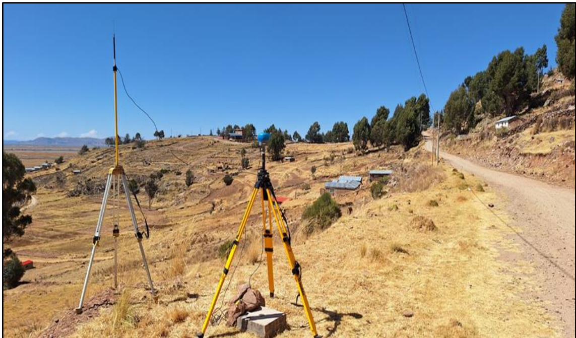
Fotografía 12: Instalación de receptor GNSS, configuración base con antena externa del R10 Trimble, en la poligonal abierta.
