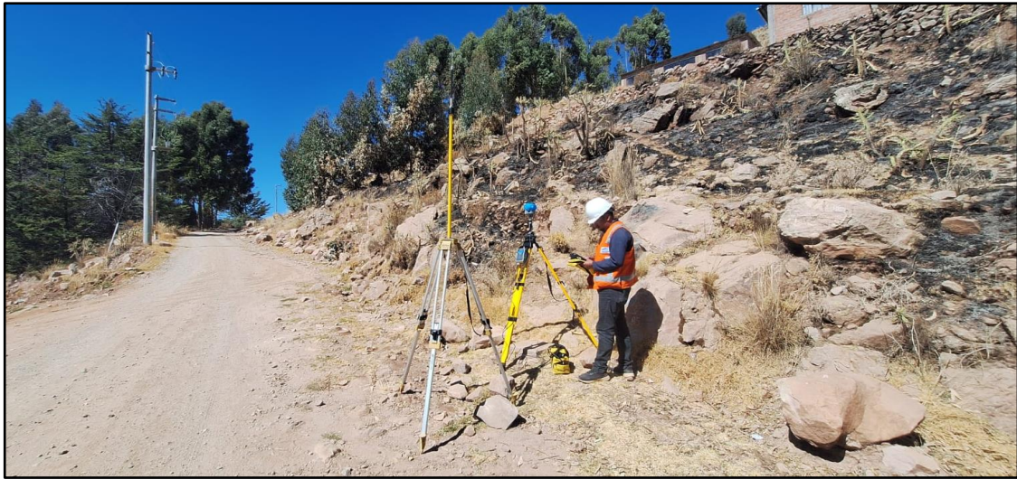
Fotografía 16: Instalación de receptor GNSS, configuración base con antena externa del R10 Trimble.
