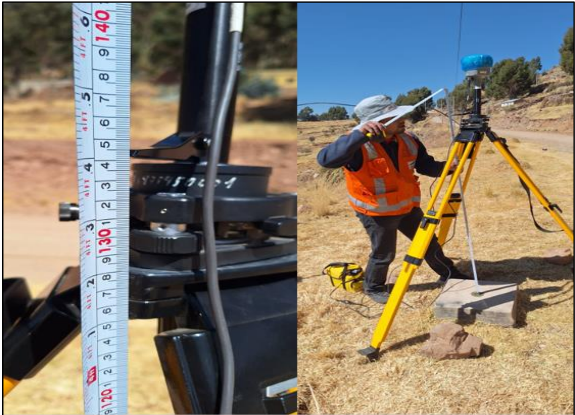
Fotografía 12: Instalación de receptor GNSS, configuración base con antena externa del R10 Trimble, en la poligonal abierta.
