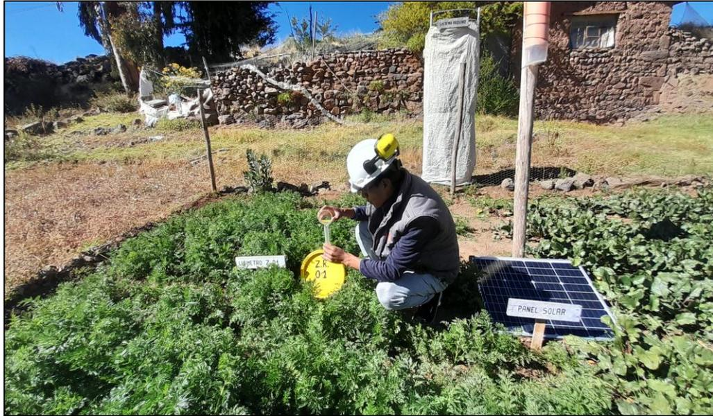
*Foto 11.* Medición del agua drenada extraída de la zona de recolección.
