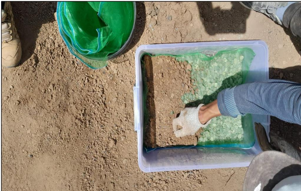
*Foto 4.* Colocación de la malla raschel por encima de la grava fina y posteriormente el llenado del lisímetro con el estrato de suelo excavado.
