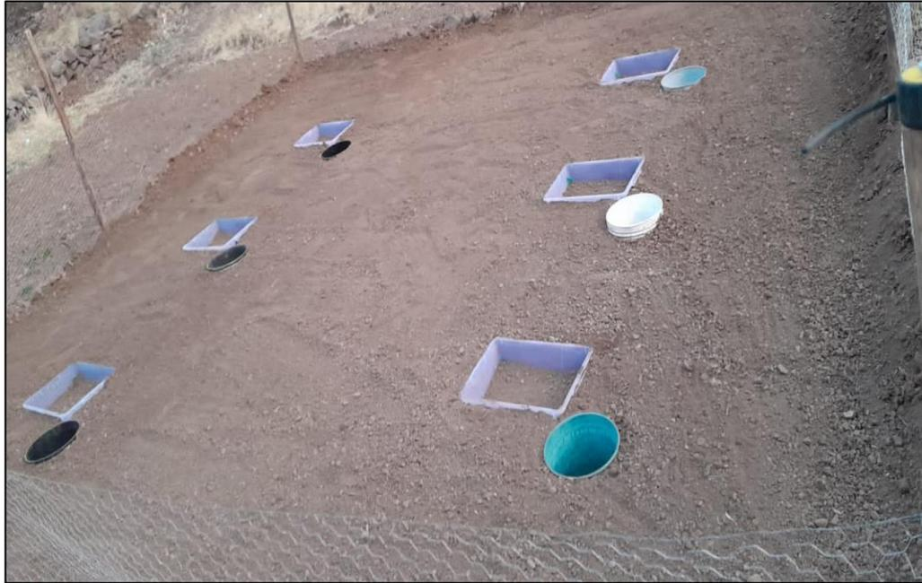
*Foto 5.* Lisímetros de drenaje instalados con una distancia de 5 cm a la zona de recolección de agua drenada.
