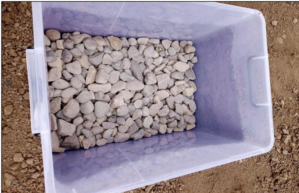
*Foto 2:* Colocación de grava gruesa de  $\varnothing 1''$ , al fondo del lisímetro por un espesor de 04 cm.
