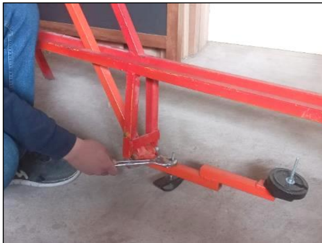
Figura 8. 10: Ajuste de tuercas del rugosímetro MERLIN
