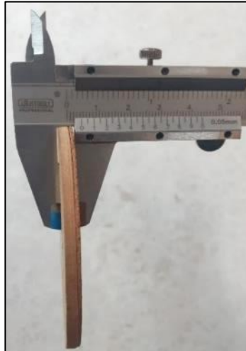
Figura 8. 12: Medición del espesor de la pastilla con el vernier
