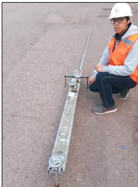
Figura 8.22: Armado de la viga Benkelman en campo
