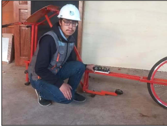
Figura 8. 9: Nivelación del rugosímetro MERLIN
