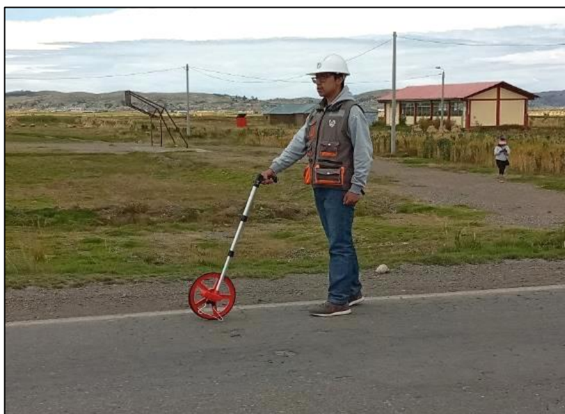
Figura 8. 3: Medición de distancias con el odómetro manual
