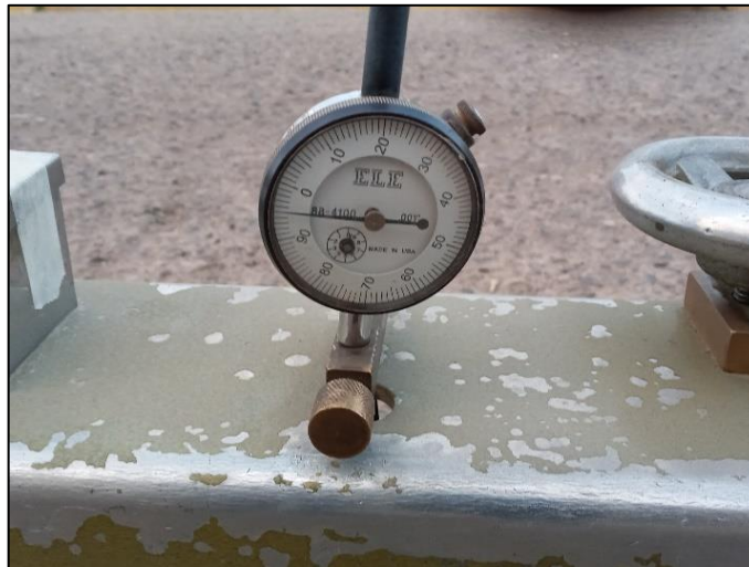
Figura 8.23: Lectura del extensómetro de la viga Benkelman
