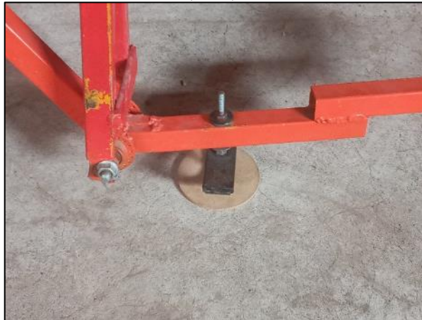
Figura 8. 11: Pastilla de calibración debajo del patín móvil
