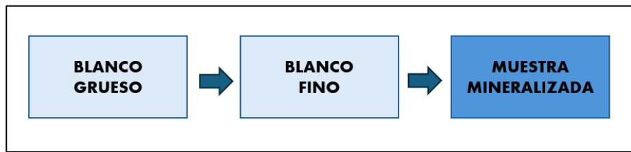
Figura 4 Diagrama inserción de muestras (blancos grueso y fino).
