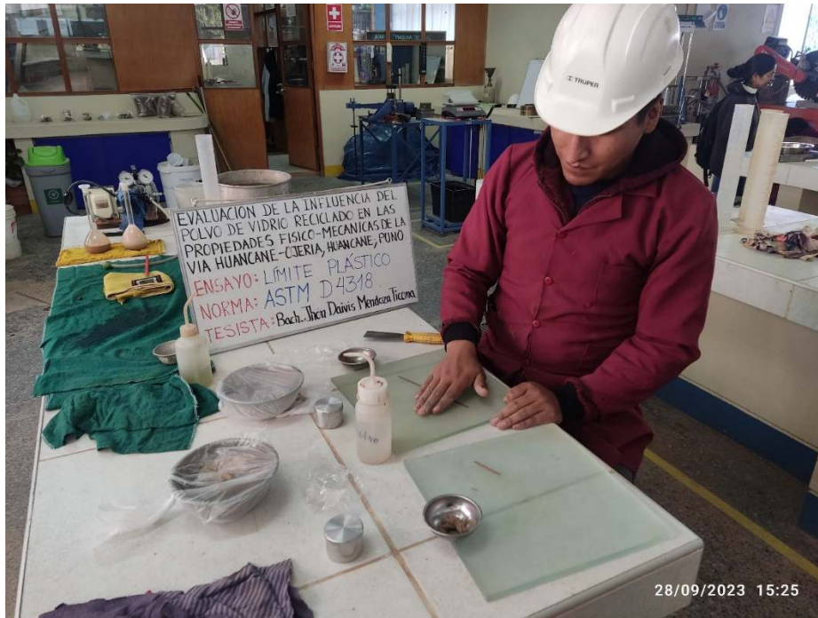
Fotografía 9. Prueba de límite plástico
