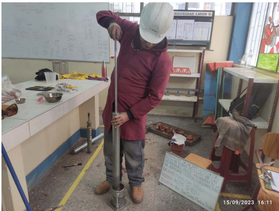
Fotografía 10. Compactación del material de subrasante
