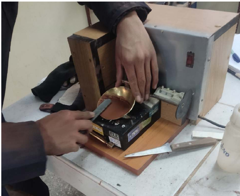
Fotografía 8. Prueba de límite líquido
