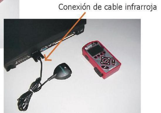
Comunicación con un puerto USB y cable adaptador con una conexión de cable infrarroja
