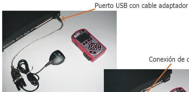
Comunicación con un puerto de serie con una conexión de cable infrarroja
