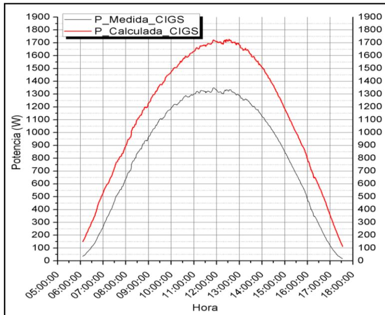
Nota: La figura muestra la potencia real y la potencia calculada para el sistema CIGS
