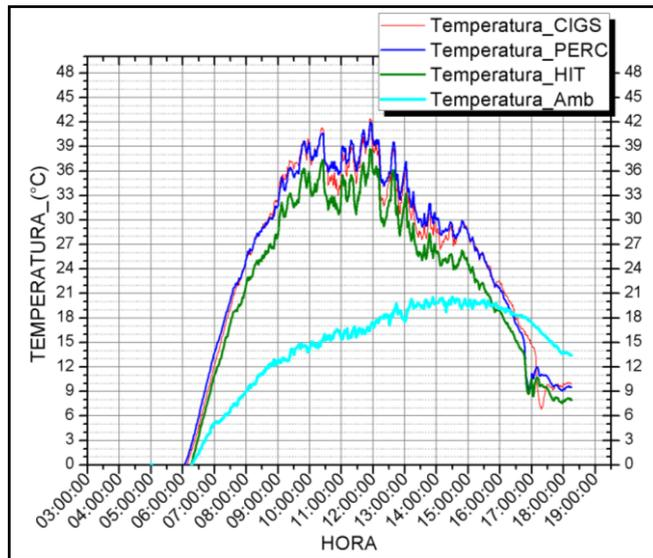
Nota La figura muestra la temperatura de los 4 sistemas en un día soleado con cielo limpio.
