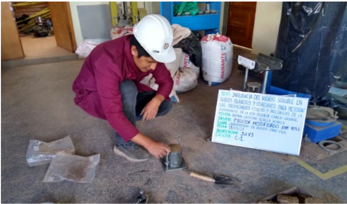
Fotografía N° 09: Ensayo Proctor Modificado
