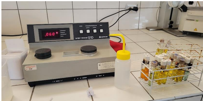
Figura A34. Medida de la transmitancia en el espectrofotómetro.
