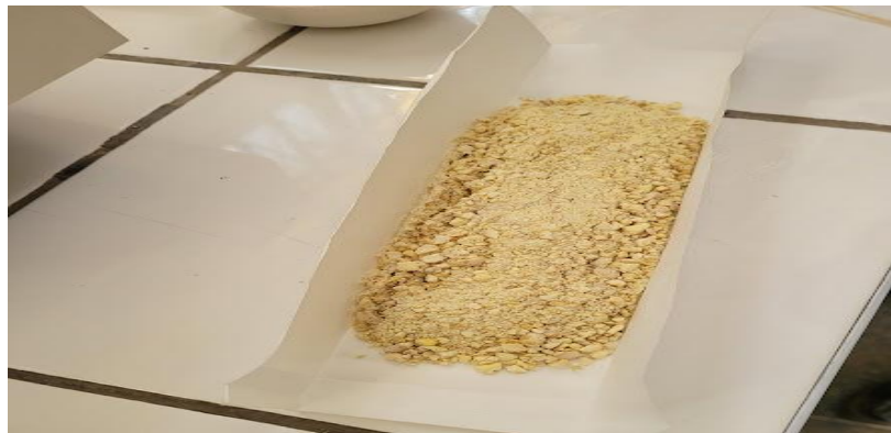
Figura A8. Envolviendo la materia prima (Moringa) en papel filtro para desengrasar.
