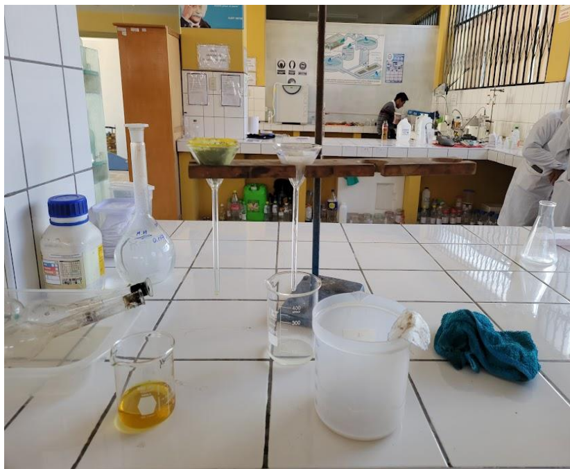
Figura A29. Filtración de muestras, luego del test de jarras.
