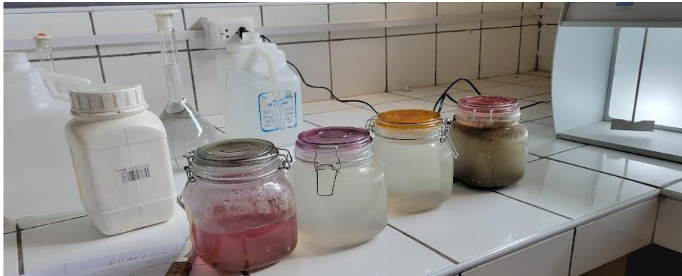
Figura A26. Las cuatro muestras en el test jarras para Malva AC.
