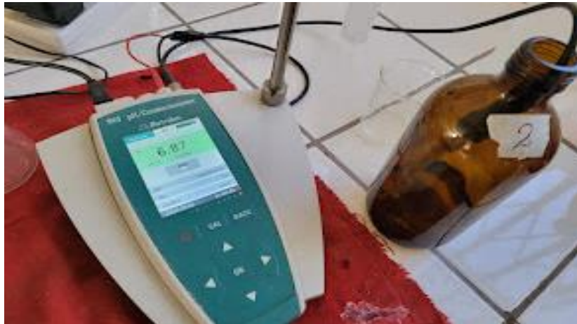
Figura A28. Calibración de sensores para la medida de DBO 5 .
