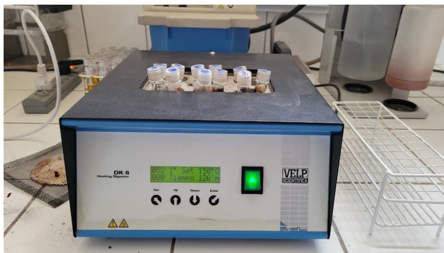
Figura A32. Proceso en el digestor para encontrar el DQO.
